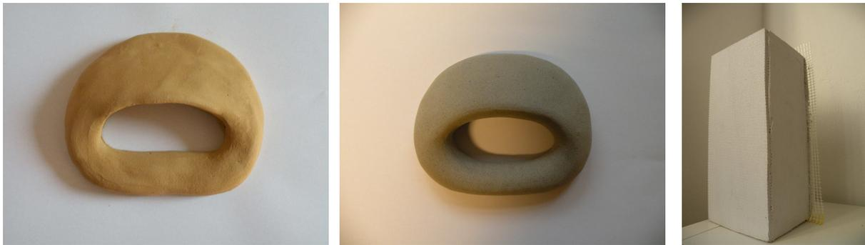
Abb. 3: Geplante Einflugrosette mit Einflug von unten aus Ton (links) und aus Blähglasgranulat (mittig) gefertigt sowie Kastenform mit Putzgrund gestrichen (rechts).
