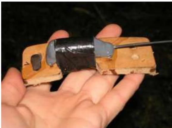
**Abb. III-06:** Telemetrie-Sender vom Typ RI-2C (Bild: Geidel)
