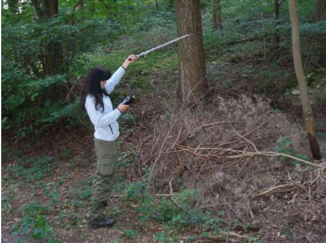
**Abb. III-12:** Datendownload der vom GPS-Logger erfassten Lokationen mittels Basisstation und gekoppelter Yaggi-Antenne (Bild: Tórizs).
