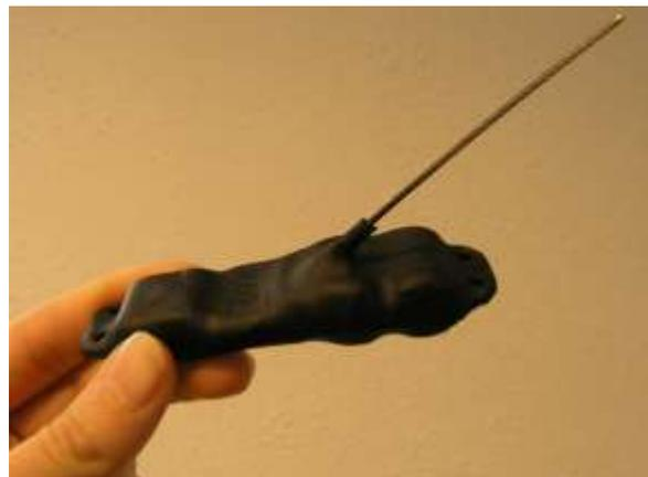
**Abb. III-07:** GPS-Logger vom Typ 2AA2 (Bild: Geidel).
