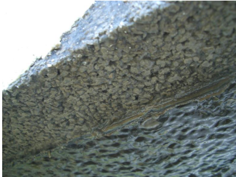
Abbildung 5-1: Bentonitschlamm aus Bautätigkeit auf einem Filterelement, welches vollständig kolmatiert ist [Dierkes, 2009]
