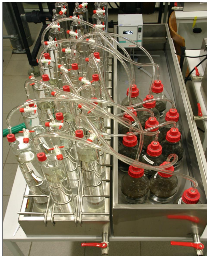
Abbildung 8-1: Versuchsaufbau zur Biogasbestimmung
