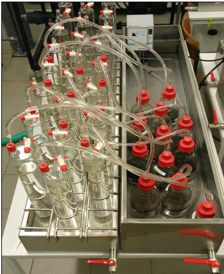
Abbildung 7.1: Versuchsstand zur Biogasbestimmung
