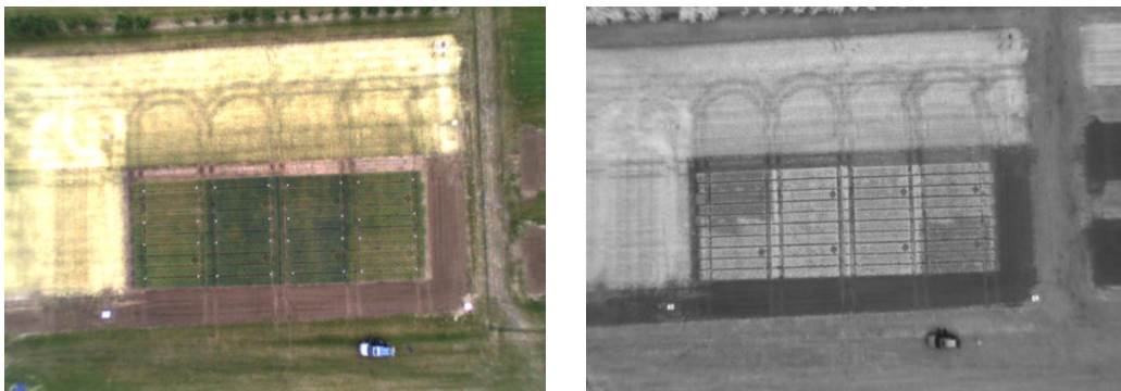
Abb.4: Beispiele geometrisch korrigierte Bilder RGB(links)- und NIR(rechts), Stand 2010. Aufnahmen vom Oktokopter ( HiSystems GmbH) mit fixer Digitalkamerachse . (Versuchsfläche ATB, Marquardt).
