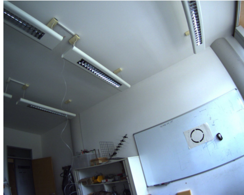
Abb. 14: Beispielaufnahme aus der Vignettierungsmessreihe. Das Zielobjekt ist die Fläche innerhalb des schwarzen Kreises.
