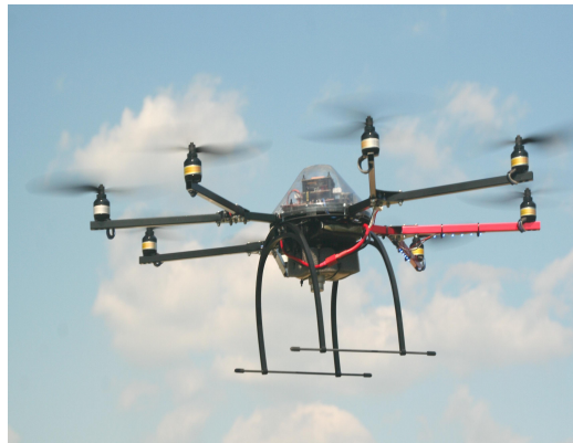
Abb.2: Agricopter Prototyp Stand 2010 basierend auf dem Oktokopter der Firma HiSystems GmbH mit fixer Digitalkamera.
