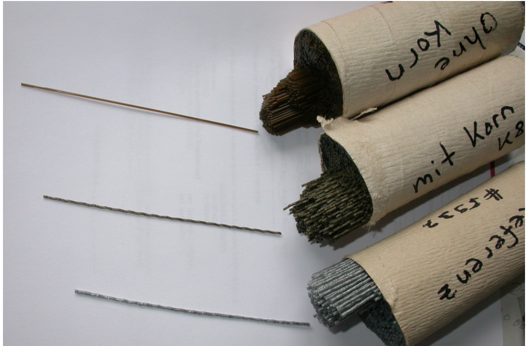
Abbildung 20: Schleifborsten aus Recycling PA-6.12 im Vergleich zum Referenzprodukt
