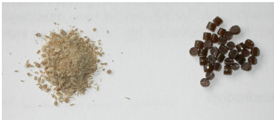
Abbildung 16: Getrocknetes PA 6.12 Recyclatpulver und daraus erstelltes Regranulat
