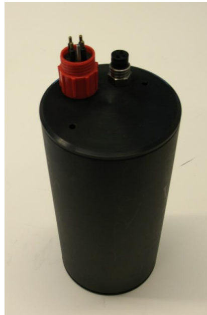
Abbildung 18: Kunststoffgehäuse für die Messelektronik. A: Am Fischereihafen. B: Für den Unterwasser-Einsatz an der Lune (L=275mm und D=135mm (ohne Steckverbinder)).
