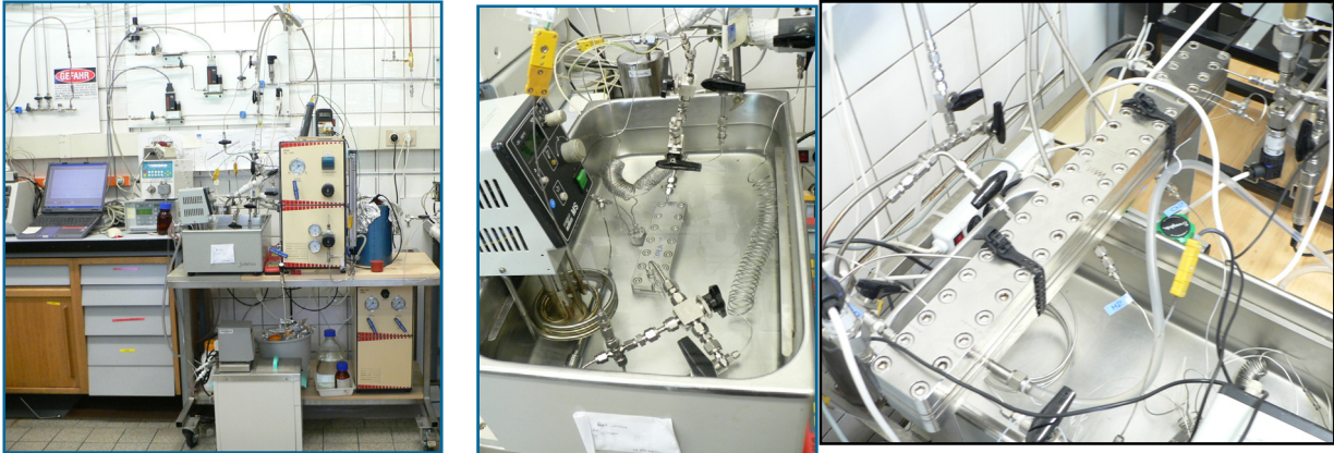
Abb. 2: Bilder des Laborsystems: links - Gesamtansicht; Mitte - Reaktiver Teil mit Temperierung für Katalysator-Screening; rechts - reaktiver Teil – Doppelmembranmikroreaktor
