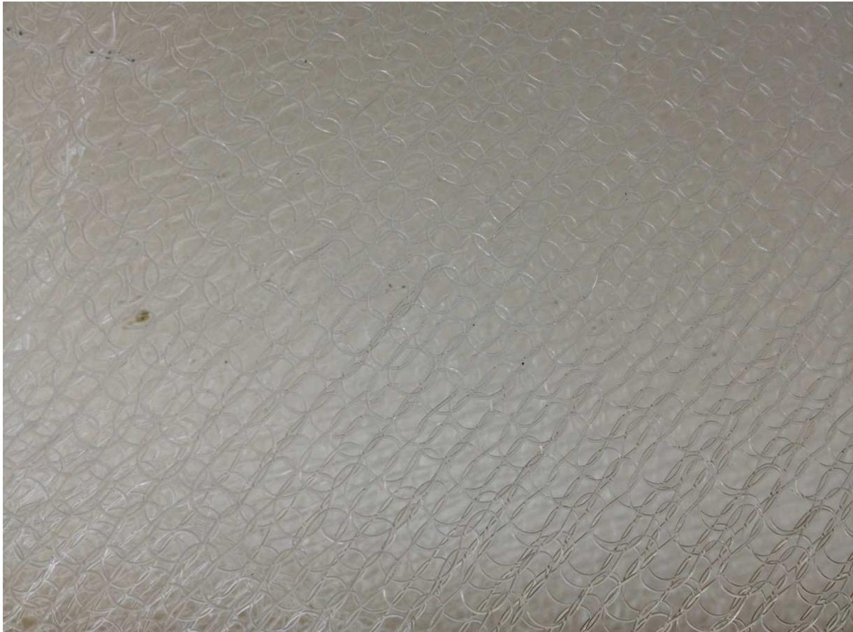
**Abbildung 10:** Tropfenabscheidergewebe aus Kunststoff
