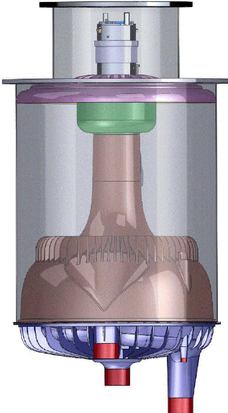
**Abbildung 18:** Entwurf einer Druckstufe aufgebaut mit Spritzgussteilen. Integriert in einen Behälter sind Verdampfer, Verdichter und Verflüssiger.
