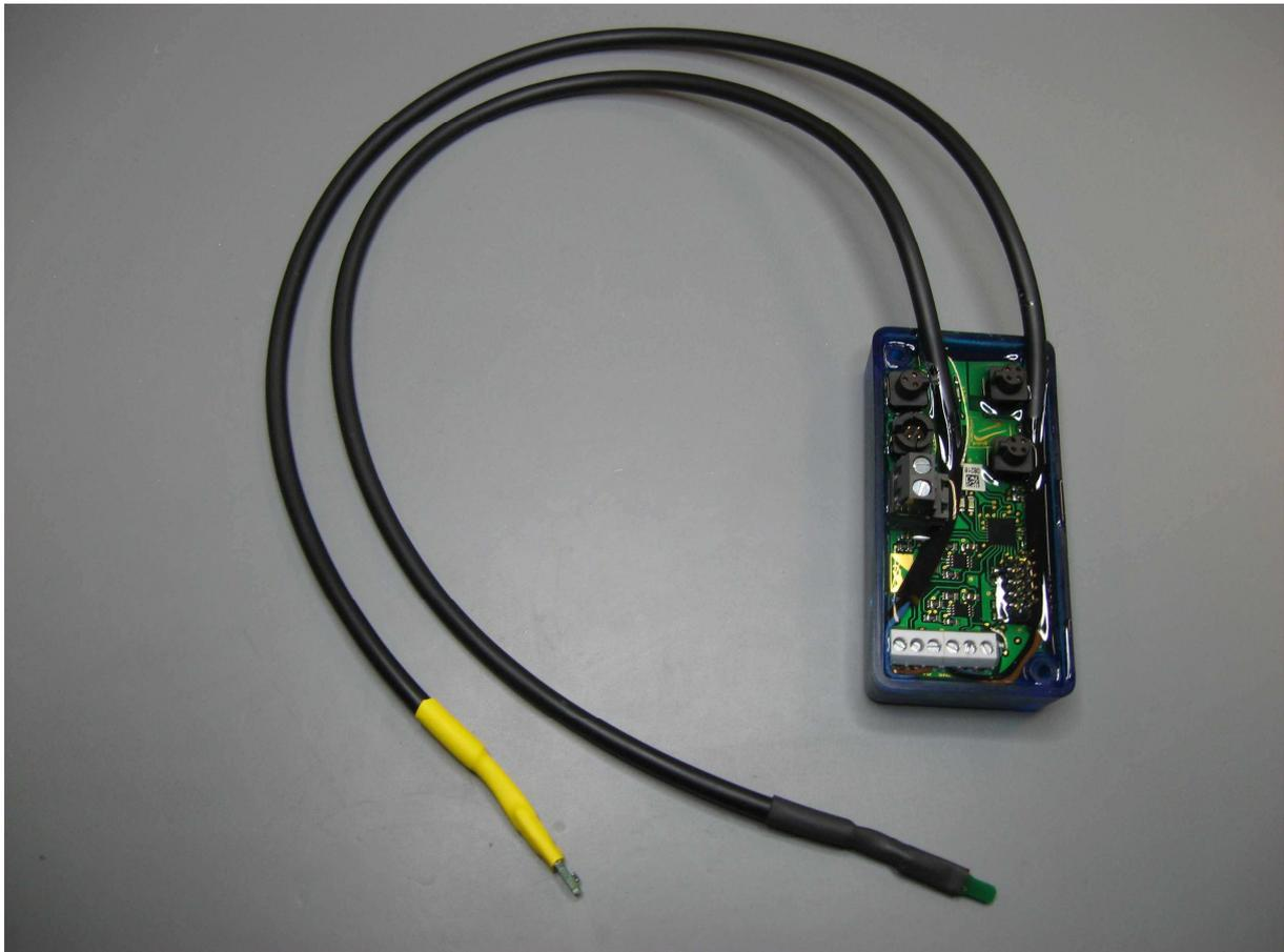
**Abbildung 14:** Zwei Temperatursensoren mit wasserdicht vergossener Platine
