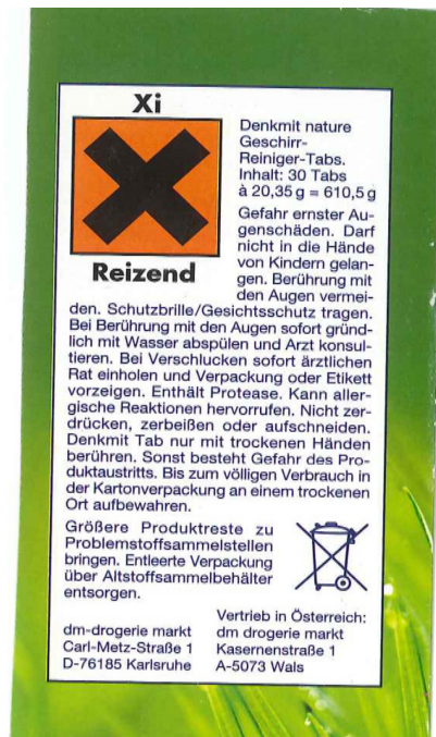
Abb. 3.1: Links: Bildausschnitt einer Geschirrspül-Tablets Verpackung. Das Reinigungsmittel ist reizend und es wird unter anderem das Tragen von Gesichtsschutz / Schutzbrille empfohlen. Rechts: Bild einer Zapfsäule. Ottokraftstoff ist giftig, hochentzündlich und umweltgefährlich.
