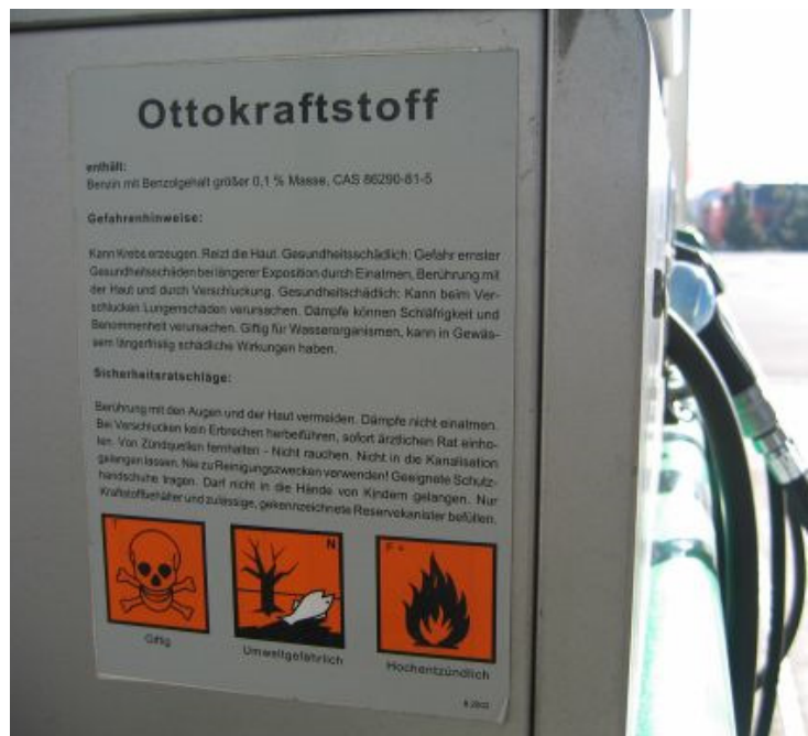
Abb. 3.1: Links: Bildausschnitt einer Geschirrspül-Tablets Verpackung. Das Reinigungsmittel ist reizend und es wird unter anderem das Tragen von Gesichtsschutz / Schutzbrille empfohlen. Rechts: Bild einer Zapfsäule. Ottokraftstoff ist giftig, hochentzündlich und umweltgefährlich.
