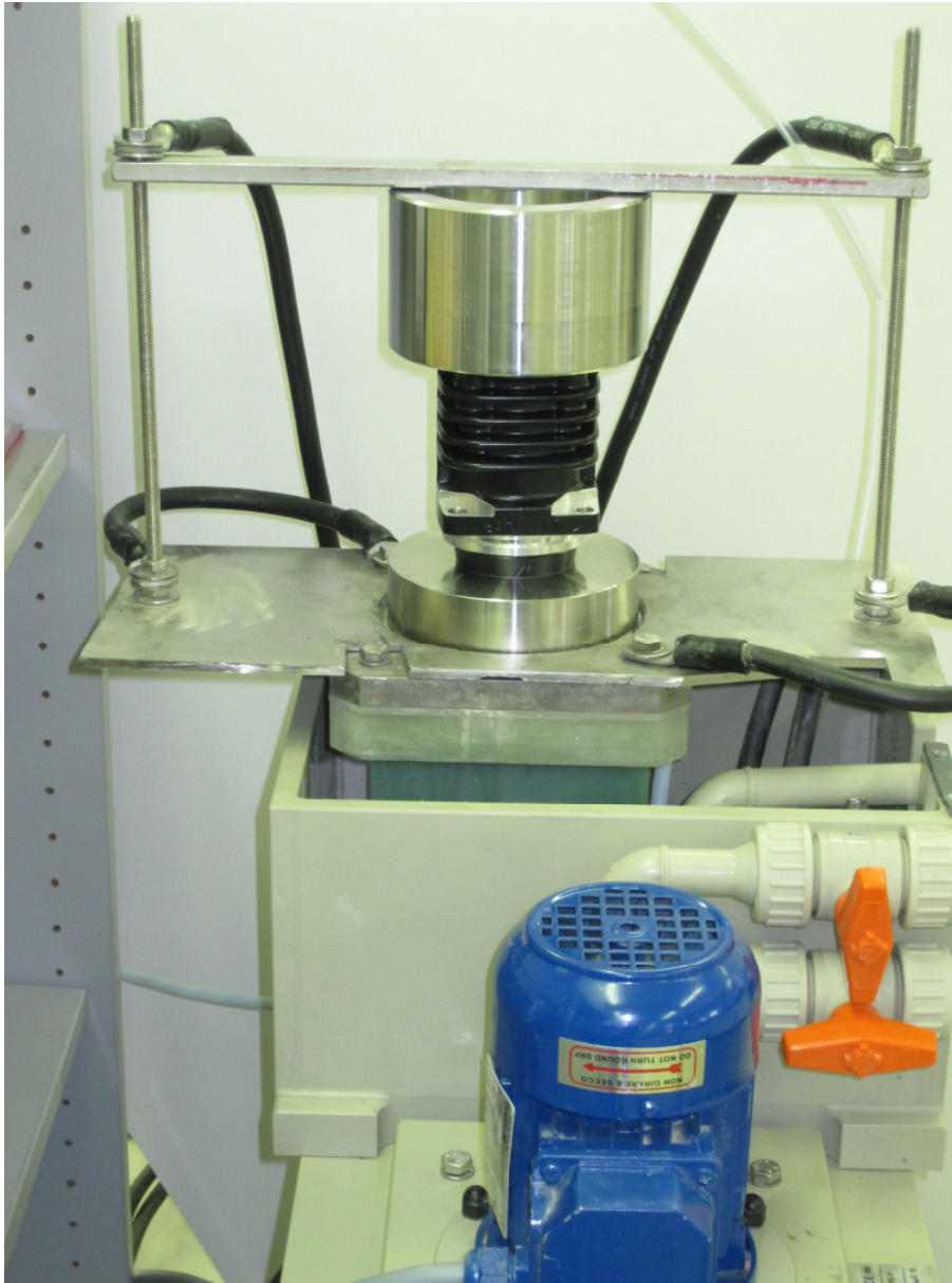
Abbildung 75: Technikumsanlage zur Beschichtung von Zylinderlinern
