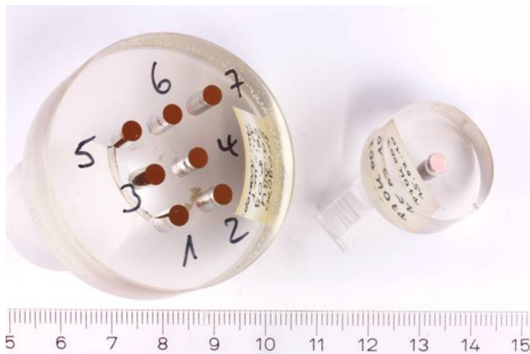
Abbildung 52: links: Standard-Schliff, rechts: Schliff zum Ionenätzen
