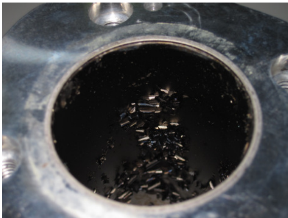
Abbildung 77: vorvernickelter, mit Nickel-nano-Gold beschichteter Zylinderliner
