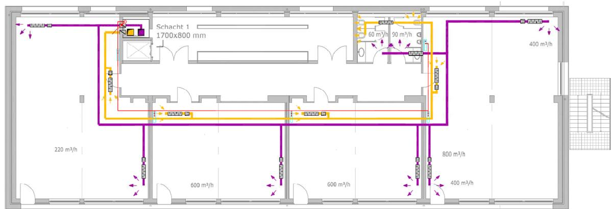
Abb. 6.15 Etagenverteilung Lüftung Trakt 1
