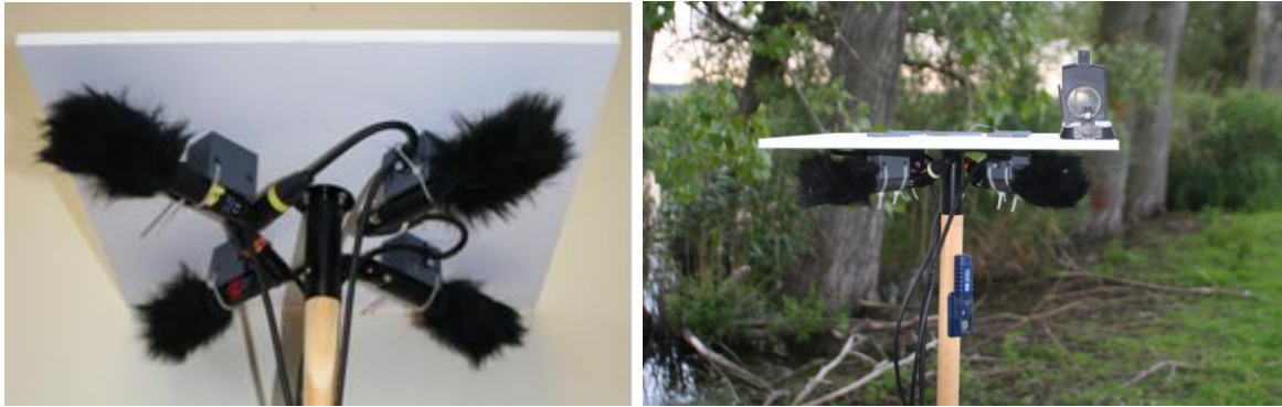
Abbildung 20: Mikrofonaufbau, der 2009 und 2010 verwendet wurde. Die Mikrofone sind durch eine Platte weitestgehend vor Regen geschützt. Eine starre Führung erlaubt eine exakte Positionierung der Mikrofone. Als Werkstoffe für den Aufbau wurden PVC, Styropor und Holz eingesetzt. Die Ausrichtung der Mikrofone wurde mittels Kompass bestimmt. Durch die feste Anbringung an der Deckplatte konnte die Peilung entlang der Deckplattenkante erfolgen. An der Stange ist der Temperatur-Luftfeuchtigkeits-Datenlogger zu erkennen.
