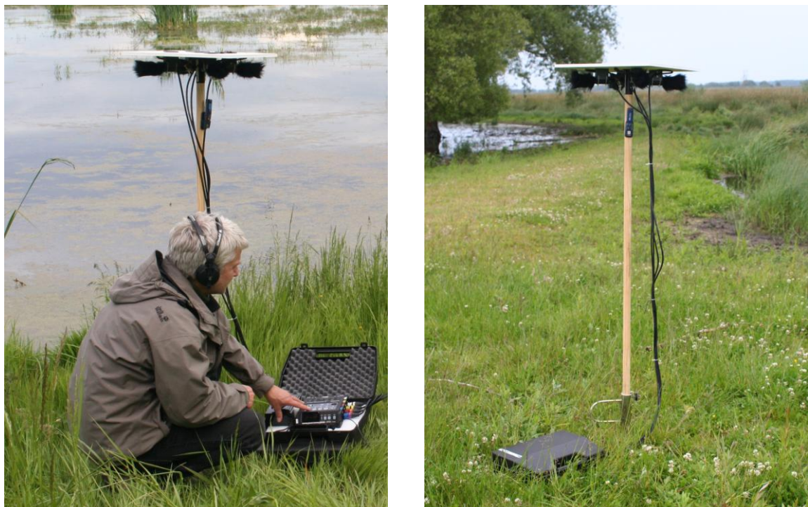
Abbildung 21: Vierkanal-Aufzeichnungseinheit im Einsatz. Recorder und Batterie sind in einem wetterfesten Transportkoffer untergebracht.
