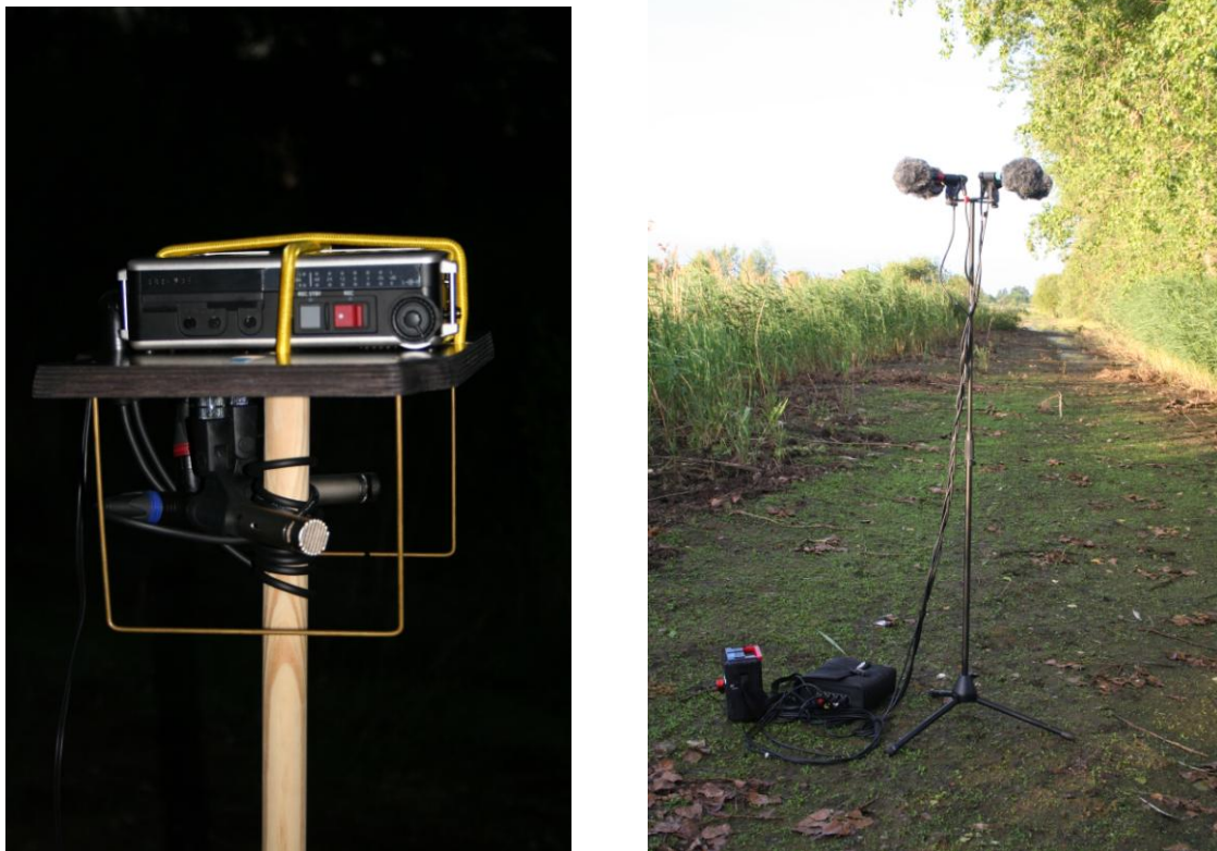
Abbildung 19: Aufzeichnungstechnik im Jahr 2008: links Recorder Fostex FR2-LE mit 2 Mikrofonen Behringer B5, rechts Vierkanalrecorder Edirol R4 mit 4 Mikrofonen Sennheiser ME64.
