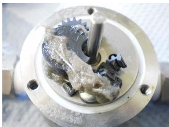
**Abbildung 23:** Schaden an der Fütterungspumpe (Fotografie).
