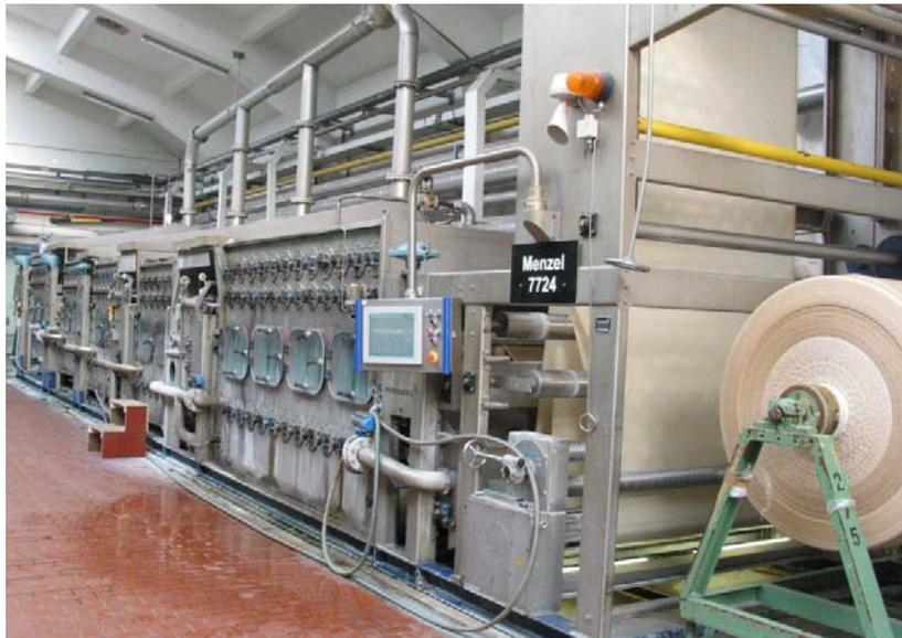
**Abbildung 8:** Gesamtaufnahme der industriellen Waschmaschine mit Dämpfer und 4 Waschabteilen.
