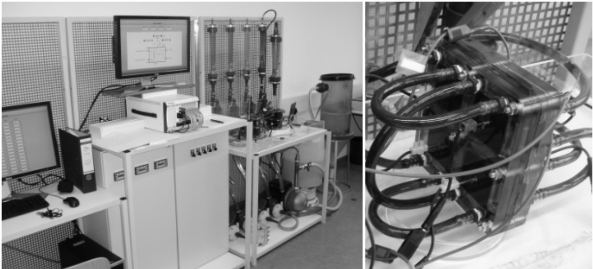
Abbildung 5: MBZ-Prüfstand (links) und Ansicht eines Zellenmoduls mit vier Einzelzellen in Reihenschaltung (rechts)
