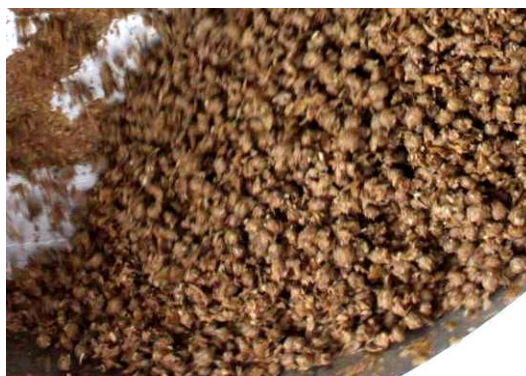
Abbildung 14: Treber im Tellergranulator während der Granulation
