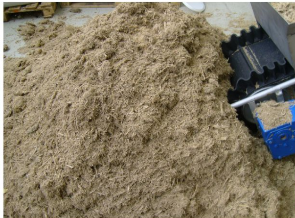
Abbildung 8: Bagasse (Anhang A5), vorbereitet für Versuche mit der Kollermühle der Fa. KAHL
