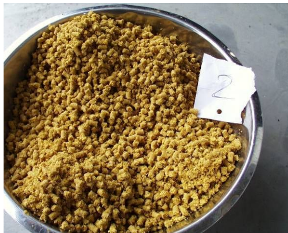
Abbildung 6: Mit der Kollermühle hergestellte Maispellets, Bohrung Matrize 5 mm
