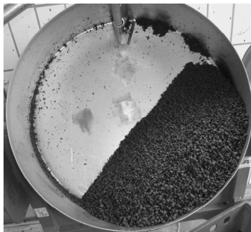
Abbildung 15: Klärschlammgranulate im Tellergranulator
