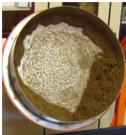
Abbildung 13: Zerkleinerte Bagasse während der Granulation im Tellergranulator
