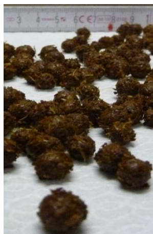
Abbildung 12: Weizen-Gerste-Mais-Schlempesgranulate (aus rückbefeuchtetem Material) mit erhöhtem Faseranteil an der Außenseite der Granulate
