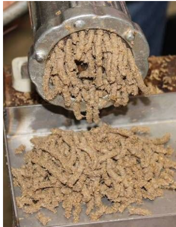
Abbildung 4: Formgebung von Treber mit einem Handfleischwolf
