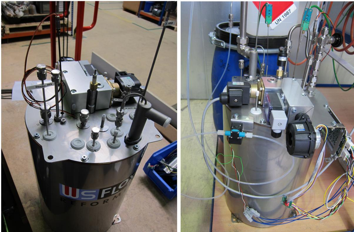
Abbildung 14: Zusammenbau Reformersystem mit Flüssigbrenner und Luftversorgung
