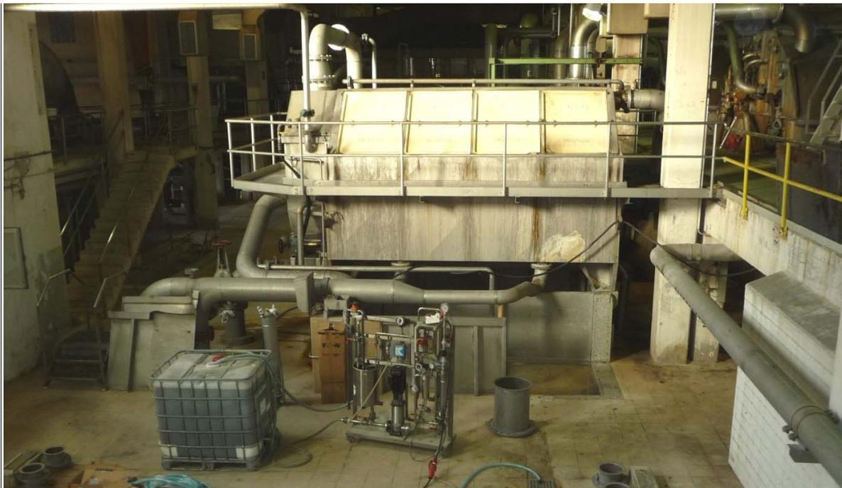
**Abbildung 13: Installation und Inbetriebnahme von Pilotanlage Olivia 2.0 der Fa. OSMO Membrane Systems GmbH bei Sappi Ehingen GmbH**
