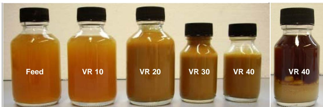
**Abbildung 25: Konzentratproben bei unterschiedlicher Volumenreduktion, rechts: Probe nach dem Absedimentieren**
