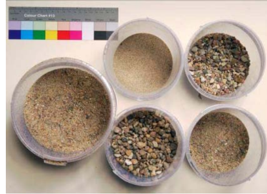
Abb. 461: Beispiele für die bei der Nachstellung verwendeten Sande mit nachgestellter Sieblinie
