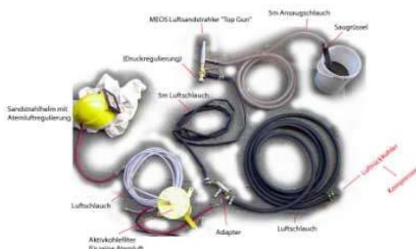
Abb. 346: Überblick über Technik des Injektorstrahlverfahrens
