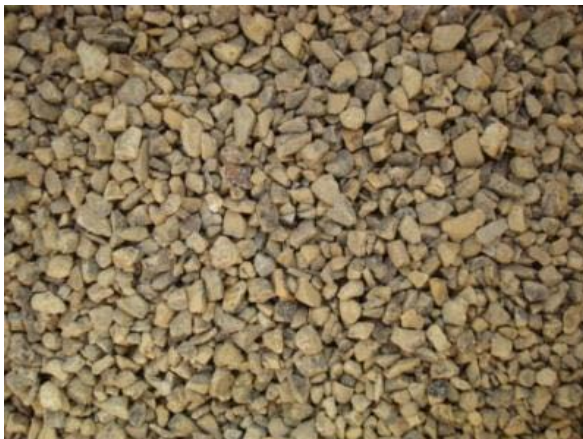
Abb. 524: grobe Dolomitsplitt der „Ostrauer Kalkwerke GmbH“ 2-5mm Dolomitsplitt.
