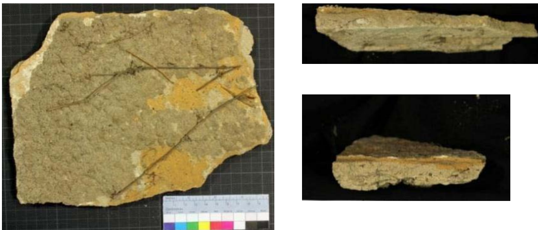
Abb. 240: Probe LAb01 mit Spritzbewurf LAb02, Landhaus Abraham, Groß Glienicke
