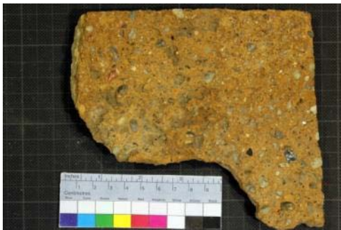
Abb. 244: Probe Amds 01 (Unterputz) und 02 (Kratzputz)
