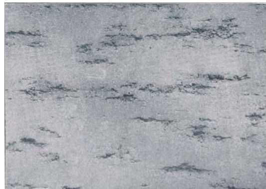
Abb. 75: überschliffen als Muschelkalk- Imitation
