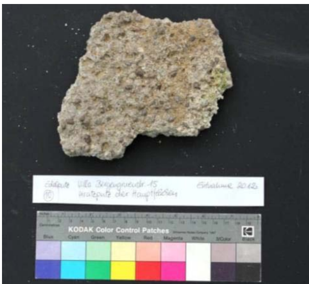
Abb. 430: Scholle 10 Vorzustand (Ionenaustauscher-Paste)
