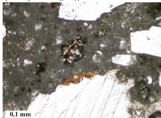
Abb. 294: DS Steinputz, nicht vollständig karbonatisiert: PZ-Klinker dicht; Kalkfiller; DL //N
