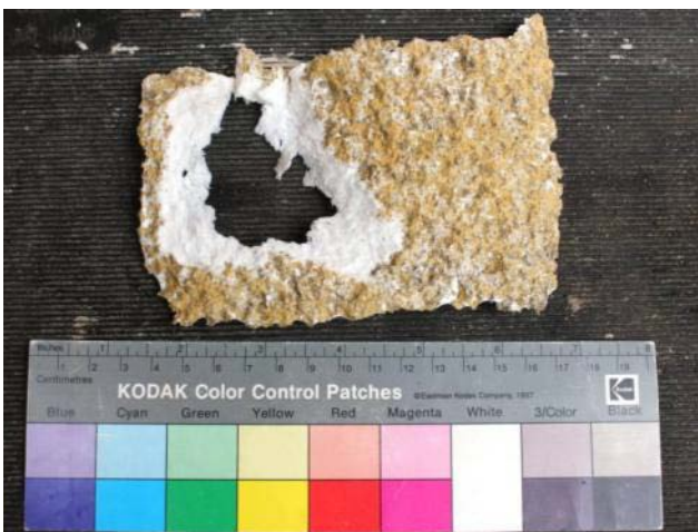
Abb. 440: abgetrocknetes Hirschhornsalz-Gel nach Abnahme mit verbleibenden Putzresten
