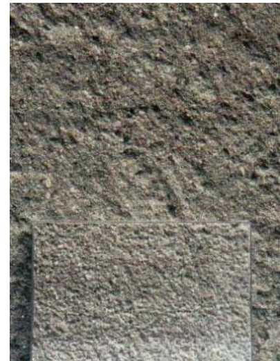
Abb. 366: Kratzputznachstellung Villa Vehse , nachträglich durch Sandstrahlen bearbeitet, um Abwitterung, sowie mit Lasur, um Verschmutzung zu simulieren
