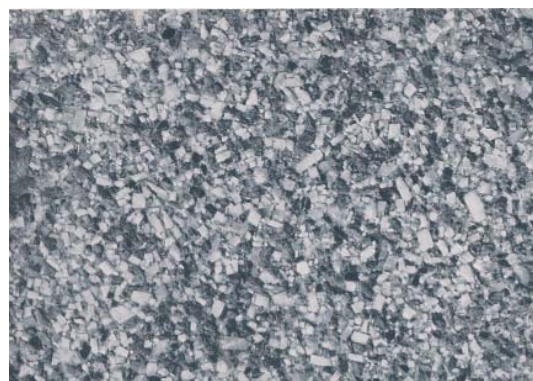
Abb. 79: Grana Waschputz mit farbl. weniger kontrast. Bindemittel-Zuschlagverhältnis
