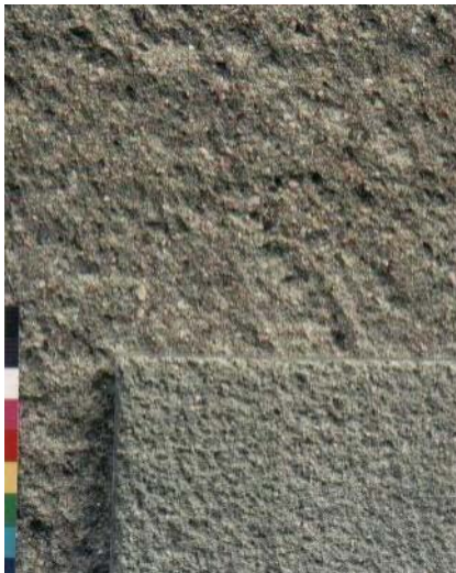
Abb. 364: Kratzputznachstellung Villa Vehse , angepasst an oberflächliche Verschmutzung
