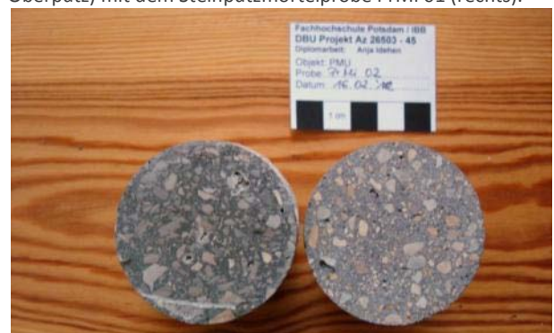
Abb. 556: Bestandsputz (links) und Steinputzmörtelprobe PrMi 02 (rechts)
