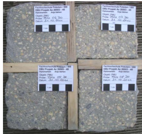
Abb. 532: Probenreihe BMZ 1:5, Erstprobenmischungen PMU05DO bis PMU08DO im Uhrzeigersinn, beginnend u.l.
