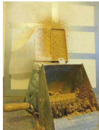
Abb. 458: Herstellen einer Probepplatte mit einer Handputzleier
