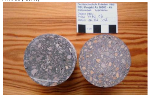
Abb. 558: Bestandsputz (links) und Steinputzmörtelprobe PrMi 03 (rechts)
