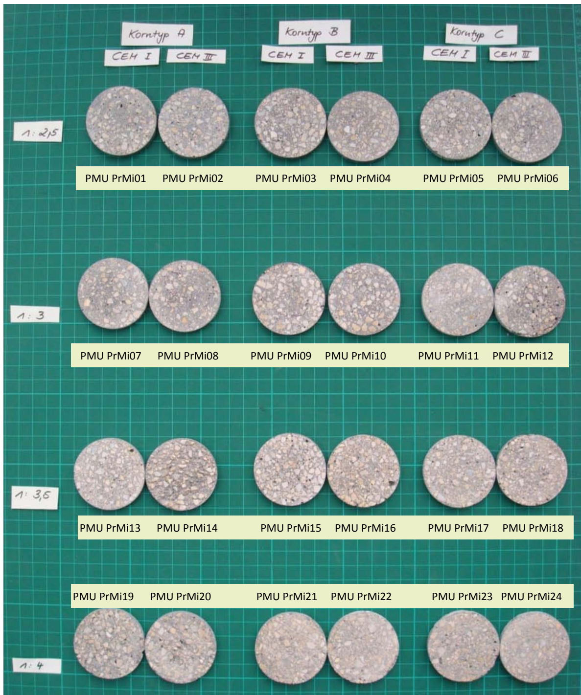
Abb. 548: je 1 zylindrischer Prüfkörper aus 24 Steinputzergänzungsmörtelmischungen
