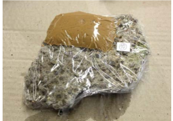
Abb. 427: Scholle 10: angetragene Ionenaustauscher-Paste mit Abdeckung aus PE-Folie
