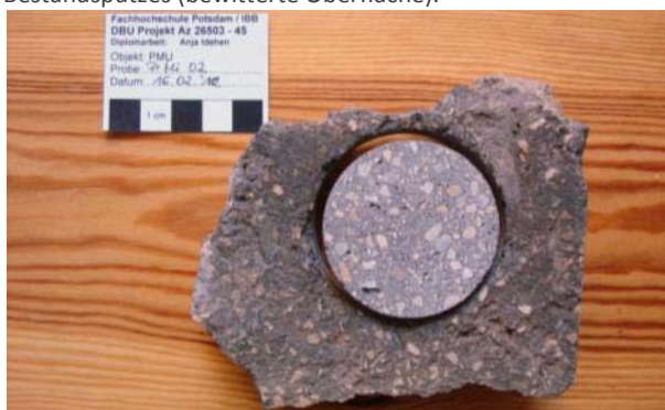
Abb. 555: Vergleich Steinputzmörtelprobe PrMi 02 mit Fragment Bestandsputz (bewitterte Oberfläche).
