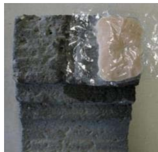
Abb. 377: Ionenaustauscherharz, Auflage abgedeckt mit Hostaphanfolie
