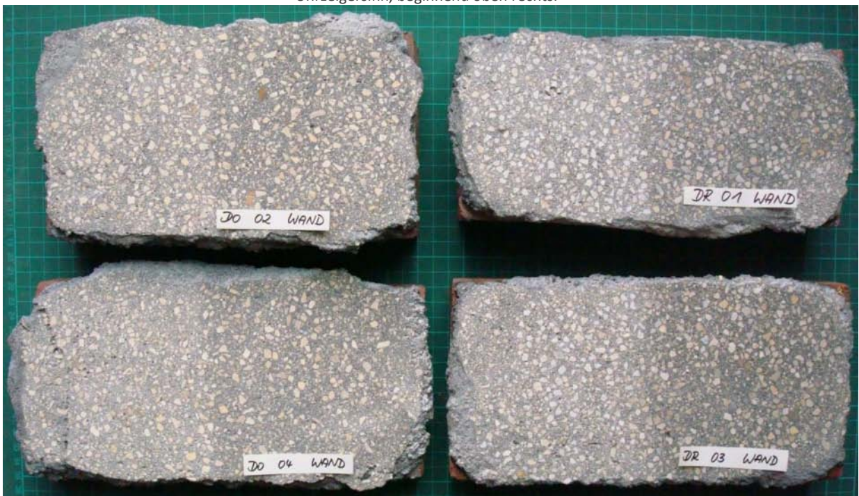
Abb. 540: Zweitproben auf mobilen Putzträgern: hellere linke Seite mittels Winkelschleifer grob geschliffen, dunklere rechte Seite mittels Schleifstein poliert. Links: DO 02 WAND und DO 04 WAND mit sächsischen Dolomitsplitt; rechts: DR 01 WAND und DR 03 WAND Steinputze mit bayrischen Dolomitsplitt.
