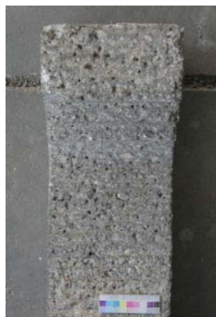
Abb. 380: Nachzustand, Reinigung mit Glaspudermehl, fein
