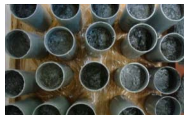
Abb. 543: Rohrabschnitte, gefüllt mit Steinputz-Probemischungen
