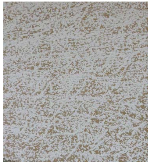
Abb. 468: Handwerkliche Nachstellung mit Werkrockenmörtel, Ausführung Ende 2010
