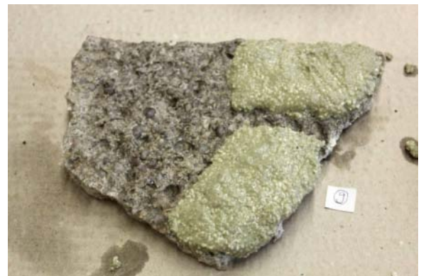
Abb. 422: Scholle 9: angetragene Hirschhornsalz-Paste
