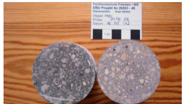
Abb. 564: Bestandsputz (links) und Steinputzmörtelprobe PrMi 06 (rechts)
