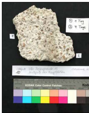
Abb. 389: Nachzustand, Reinigung mit Ionenaustauscher-Paste
