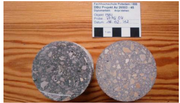
Abb. 560: Bestandsputz (links) und Steinputzmörtelprobe PrMi 04 (rechts)
