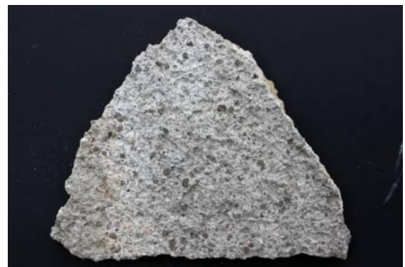
Abb. 435: Scholle 8 Endzustand (ILKA Bio-Steinreiniger)
