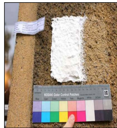
Abb. 390: Testfläche mit Hirschhornsalz-Gel, Abnahme nach 1 Tag (rechts), abgetrocknetes Material nach 4 Tagen (links)
