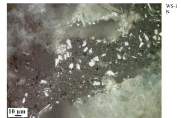
Abb. 301: DS Grundputz: feiner Hüttensand im Bindemittel; AL //N
