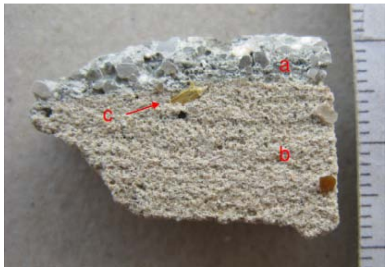
Abb. 259: Probe KuFa 01 und 02; a) Unterputz b) Oberputz c) Stroh
