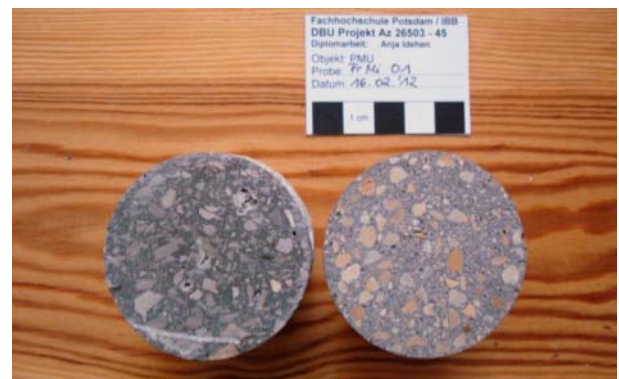
Abb. 554: Optischer Vergleich des Bestandsputzes (links - Bohrkern mit frischer Oberfläche mittels Schnitt durch den Oberputz) mit dem Steinputzmörtelprobe PrMi 01 (rechts).
