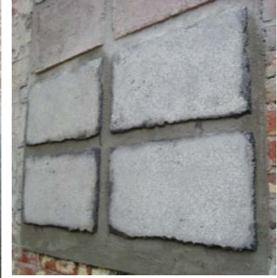
Abb. 539: Steinputzprobemischungen wie auf Abb. vor; nach Abschleifen der Oberfläche.
