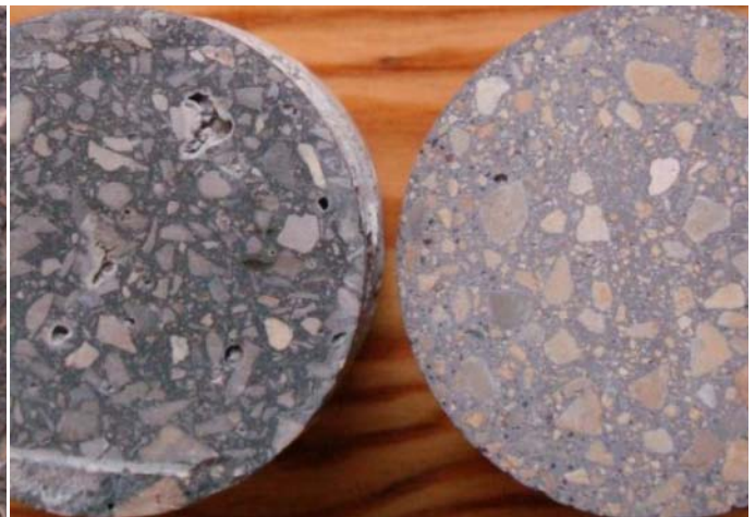
Abb. 568: Bestandsputz (links) und Steinputzmörtelprobe PrMi 04 (Hochofenzement und deshalb Bindemittelanteil etwas heller, rechts)
