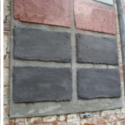
Abb. 538: Steinputzprobemischungen PMU DR 01 WAND, PMU DO 02 WAND, PMU DR 03 WAND und PMU DO 04 WAND, nach einem Tag, entgegen Uhrzeigersinn, beginnend oben rechts.
