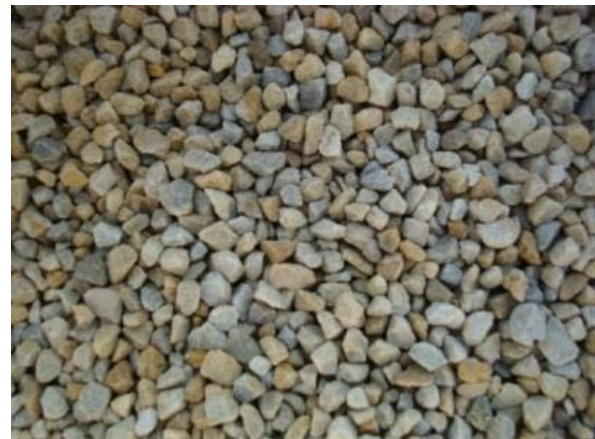
Abb. 525: grobe Dolomitsplitt der „DüKa Düngerkalkgesellschaft mbH“ 2-5mm Dolomitsplitt.
