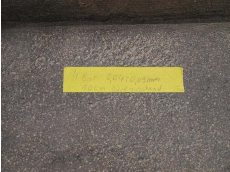
Abb. 505: Musterreinigung im Strahlverfahren mit Aluminiumsilikat 0,04-0,09 mm, 4 bar, 10cm Abstand
