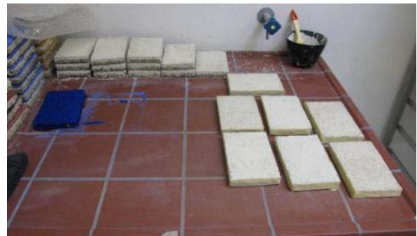
Abb. 444: Vorbereitete Platten mit Unterputz
