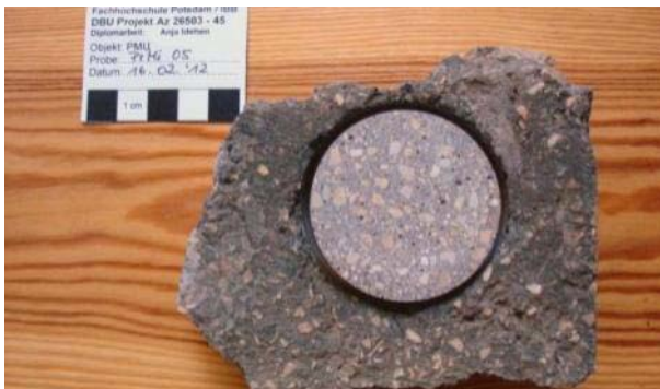
Abb. 561: Vergleich Steinputzmörtelprobe PrMi 05 mit Fragment Bestandsputz (bewitterte Oberfläche).
