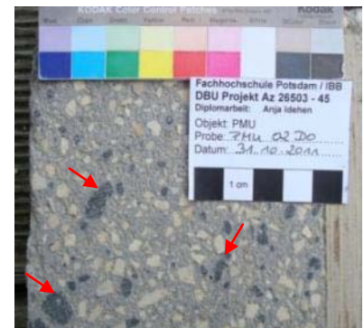
Abb. 528: Pigmentanreicherung, erste Probereihe, PrMi PMU 02 DO.
