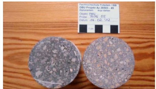
Abb. 562: Bestandsputz (links) und Steinputzmörtelprobe PrMi 05 (rechts)
