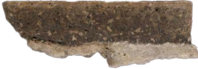
Abb. 498: Probe PMu 08, Querschnitt; unten Unterputz, oben Oberputz mit deutlich ockerfarbenen oxidierter Schicht
