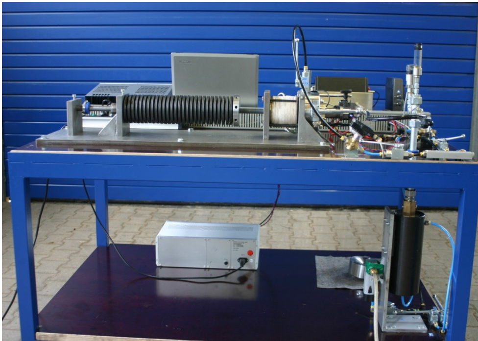
Bild 3.: Versuchstisch mit Linearmotor und Federpaket, Brennkammer
