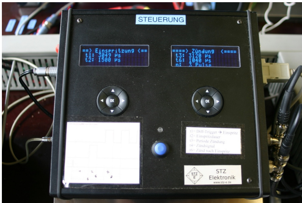
Bild 7.: Zentrale Steuerelektronik mit Präzisions-Clock-Generator
