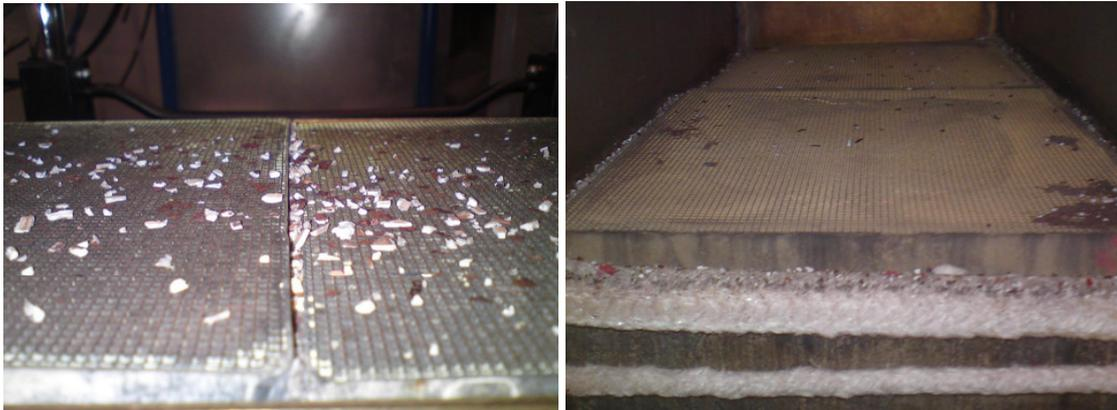
Bild 7.3.2-6: Zustand der Katalysatorlagen nach Ende der Betriebszeit innerhalb der Versuchsanlage KARLOS. Blick auf die erste (links) und zweite (rechts) Katalysatorlage
