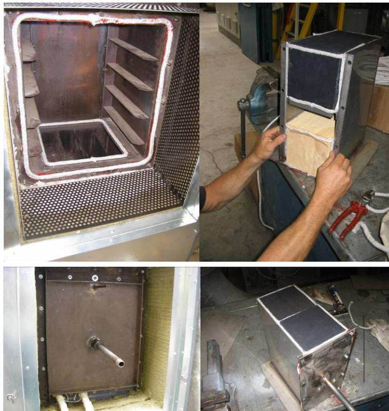
Bild 7.3.2-3: Katalysatorraum (oben links), Eindichtung der Katalysatoren (oben rechts), Einbau fertiges Katalysatorpaket (unten rechts), Katalysatordeckel an der Versuchsanlage mit Messstutzen (unten links)
