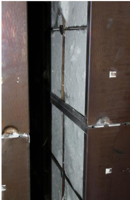
*Bild 7.5.2-1: Ablagerungen auf Katalysatoren an Füllerlinie 3, Strang 1*
