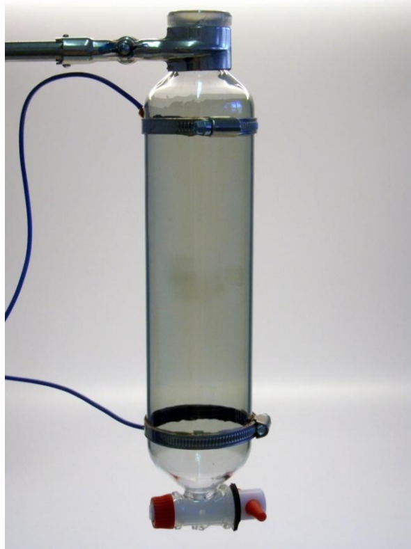
Abbildung 36. Heizversuch am 500 ml Tropfentrichter mit SnO 2 -11-fach-Beschichtung (DATC/SbF 3 /FTO-Partikel), Kaltwiderstand: 120 Ohm, Beheizung mit: 220V / 400 W, entspr. einer Flächenleistung von: P = 1,15 \text{ W/cm}^2 , Heizen von 500 ml Wasser von 25°C auf 95°C in 6-7 Minuten, Kaltwiderstand: unverändert nach 70 Heizzyklen
