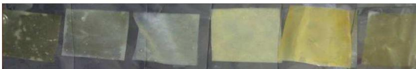
Abbildung 4-24 Kollagen-Folie nach Beaufschlagung mit verschiedenen Test-Substanzen nach 1 Stunde (von links nach rechts: Öl-Mix, Kraftstoff-Mix, Scheibenwaschwasser, VE-Wasser, NaOH, H<sub>2</sub>SO<sub>4</sub>)
