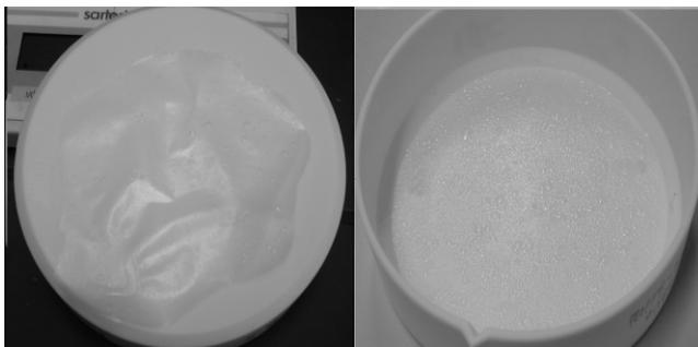
**Abbildung 4-12 Haftfestigkeit von Kollagen ohne Haftmittel (links) und mit Haftmittel (rechts) auf PTFE**
