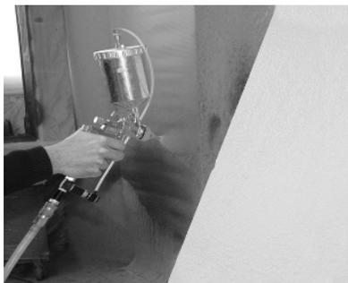
Abbildung 4-6 Sprüh-Applikation von Kollagen mit einer Becherpistole spraymaster RP (SATA) [Gokel, 2010]
