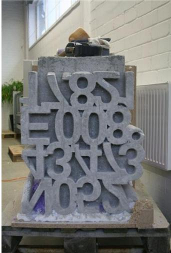
Abb. 6: Betonsockel entschalt
