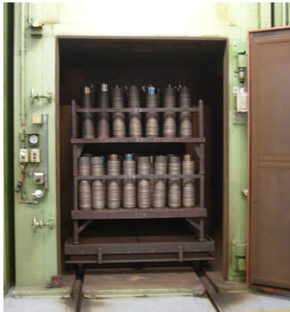
Abbildung 3: Ofen bestückt mit zwei Gestellen (Ofen-Innenmaße: 1,65 x 2,4 x 1,85 m = 7,3 m 3 )
