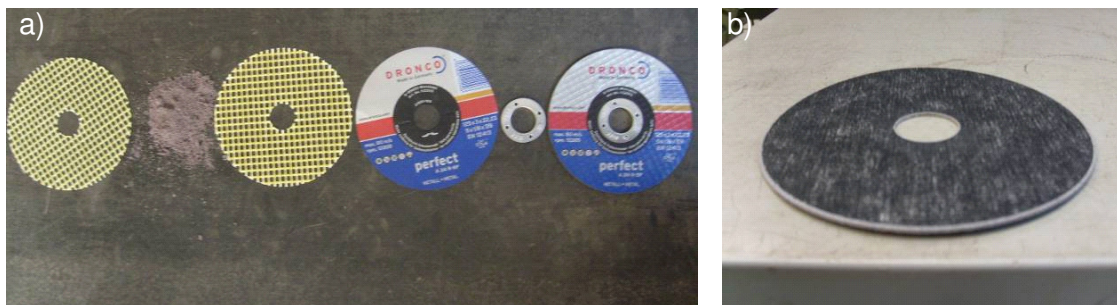
Abbildung 1: a) Trennscheiben-Komponenten (v.l.: Glasgewebe, Masse, Glasgewebe, Etikett, Ring), b) gepresster Rohling (nicht planar).
