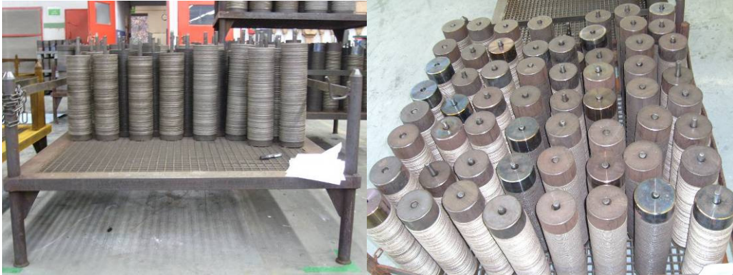
Abbildung 2: Ofengestell mit fertigen Rohlingsstapeln angeordnet in Rechteckform
