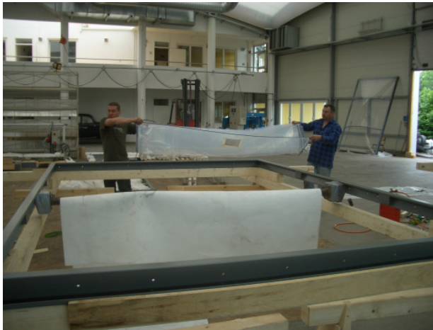
Abb. 58 Das Rahmenmodul wird mit Folie belegt
