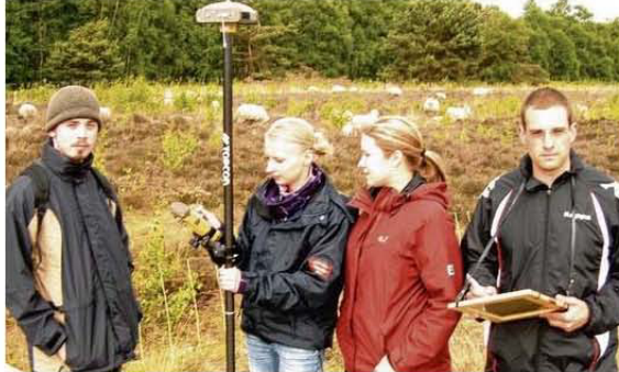
Lasergestützt und GPS-ausgerichtet, vermessen Studenten der Jade-Hochschule rund 30 Hektar Moorgelände am Moormuseum. Foto: Wilhelm Bartels
