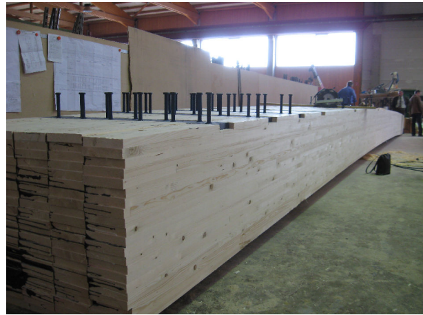
Bild 26 bis 28: Blockverleimter Holzträger mit Dübelbeiste
