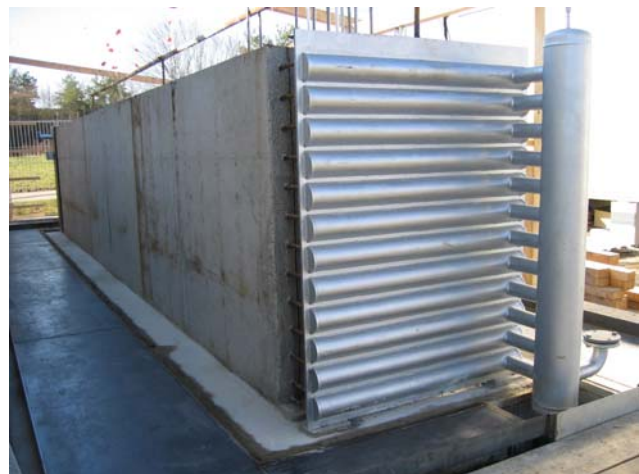
Bild 5.5: Testmodul nach dem Vergießen mit Beton, noch ohne Isolation
