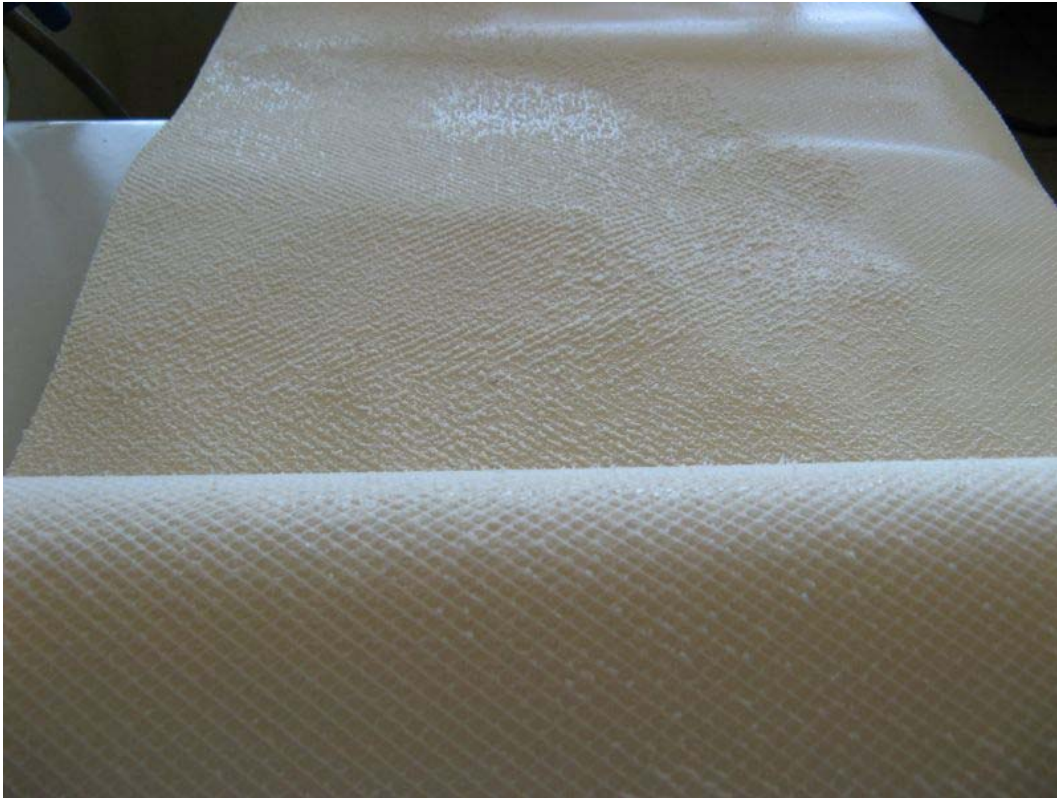
Bild 4.21: Autopsie des letzten Membranelementes mit stark (links vorne = innere Windungen im Element) und gering (rechts hinten = äußere Windungen im Element) ausgeprägten Scalingschichten
