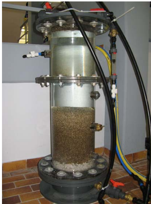
Bild 3.6: Schnellfilter zur Behandlung des Konzentrates aus der LPRO-Anlage
