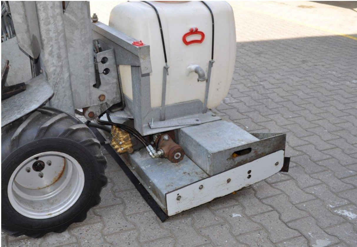
Abbildung 3: Reinigungsaggregat in der Version mit seitlichen Schürfblechen und Einzelbehälter zu Versuchsbeginn im Juni 2009.
