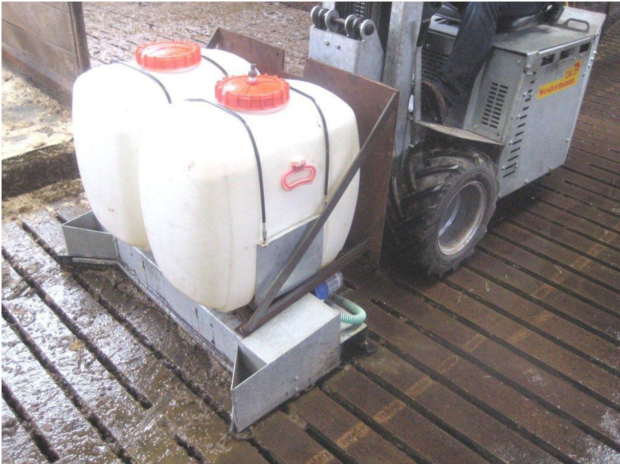
Abbildung 2: Erste Version des Reinigungsaggregats der Fa. Westermann am CM3 mit zwei Vorratsbehältern.
