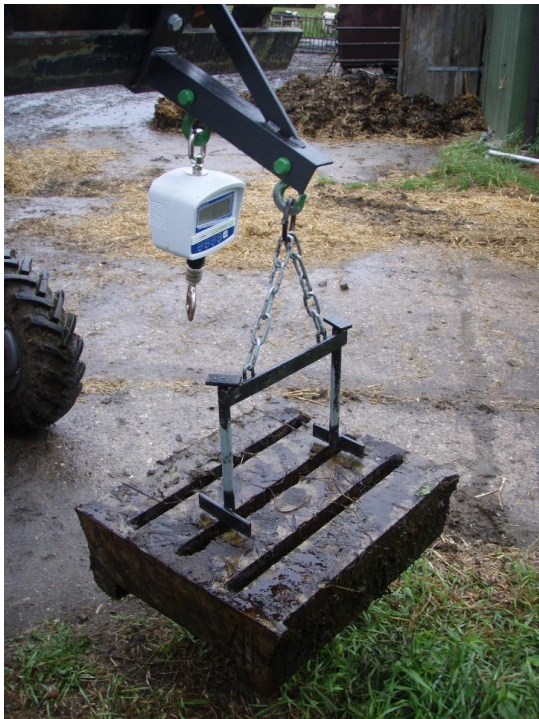
Abbildung 7: Prüfspalte mit Spaltenanker und Hängewaage
