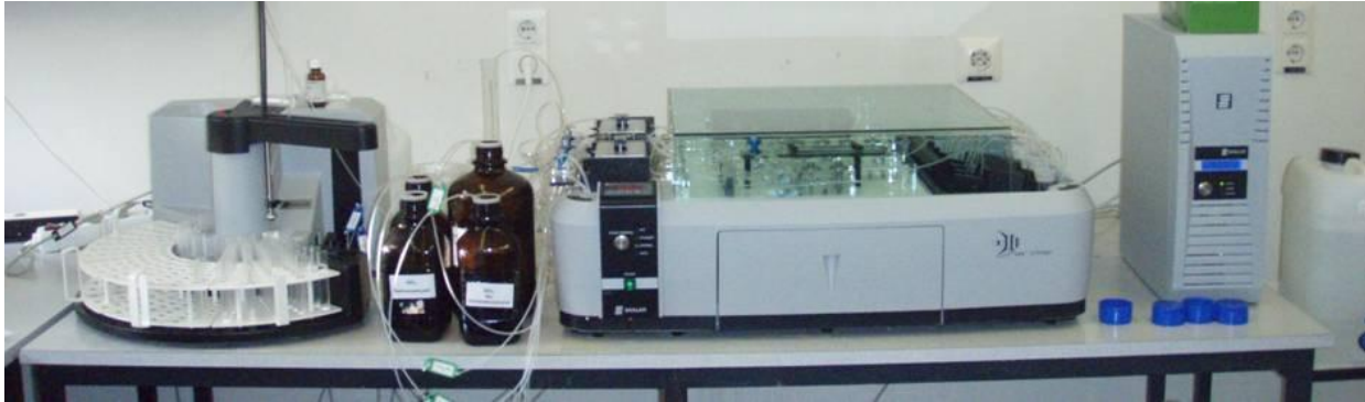
Abbildung 13: Segment Flow Analyzer zur Bestimmung der Ammoniakkonzentration (Labor des Instituts für Agrarrelevante Klimaforschung des vTI)
