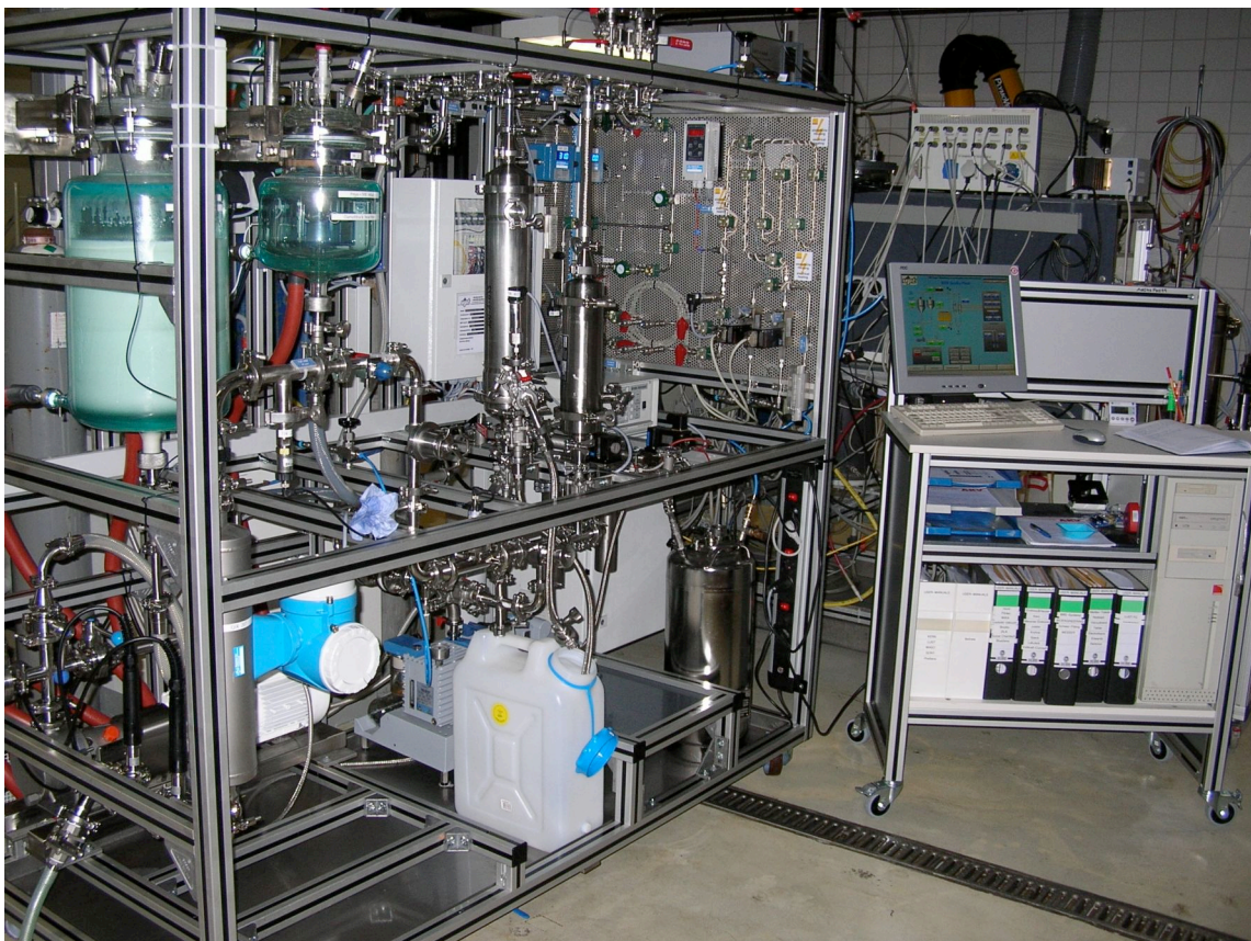
Abb. 2.1: Teilautomatisierte Versuchsanlage im Technikumsmaßstab für die Membranfiltration
