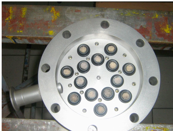
Abb. 1.4: In der Lochplatte mittels O-Ring-Dichtung fixierte Membranbündel
