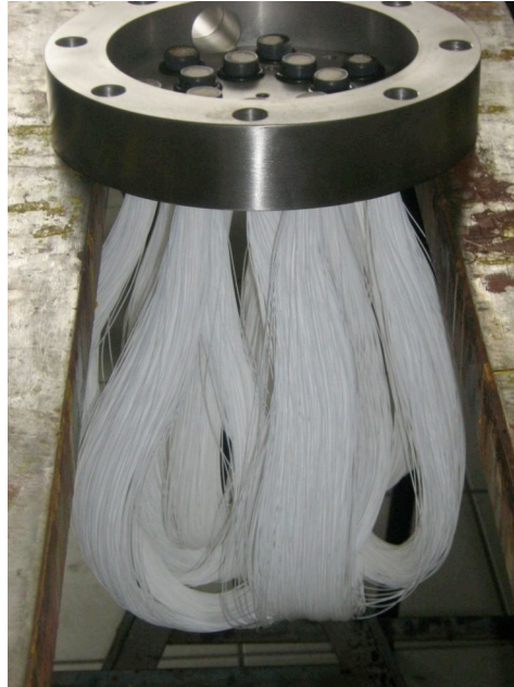
Abb. 1.3: Polypropylen-Membranbündel als Schlaufen in der Edelstahlplatte fixiert
