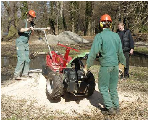
Foto 6: Stubbenfräse im Einsatz
