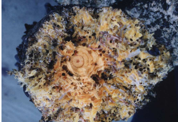
Abbildung 7: Durch Teredo zerstörter Kiefernspfahl (Weichholz)
