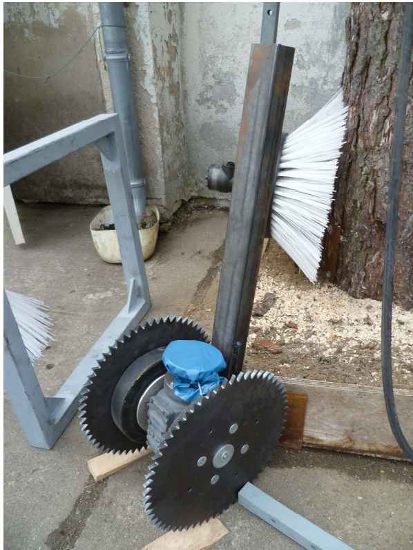
Abbildung 27: Antriebseinheit zum vertikalen Vortrieb
