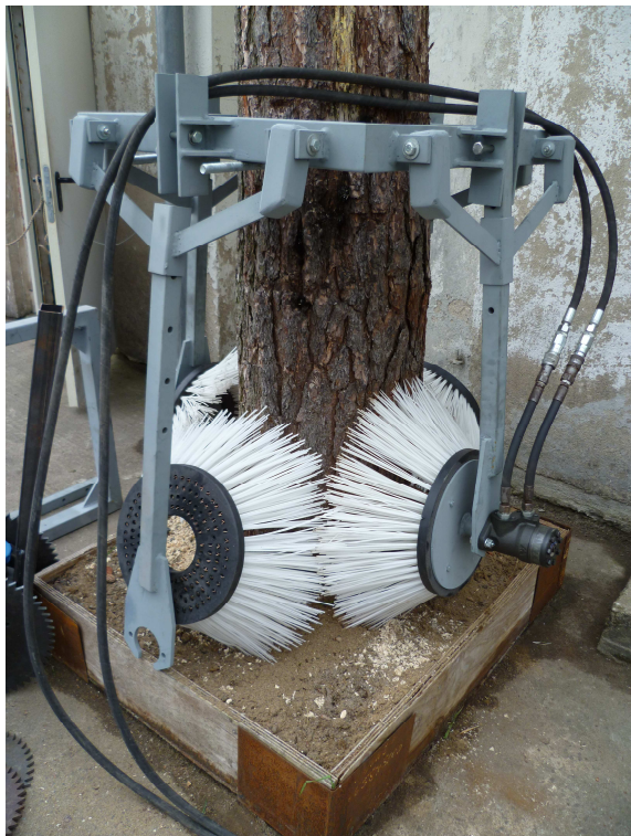
Abbildung 25: Einfacher Klapprahmen am Pfahl montiert
