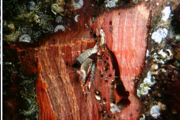
Abbildung 8: Teredo -Befall von Eucalyptus rostrata (Hartholz) (Gercken, 2008)
