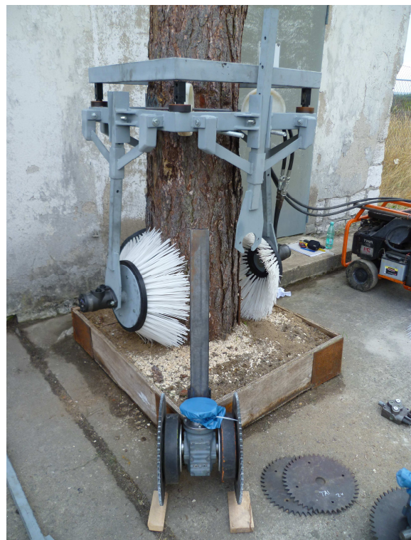
Abbildung 26: Doppelter Klapprahmen; 2 Bürsten und Antrieb zum vertikalen Vortrieb nicht montiert
