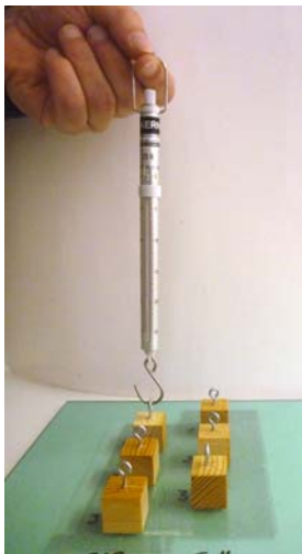
Diagramm 15 Schälwiderstand verklebter Gasplättchen
