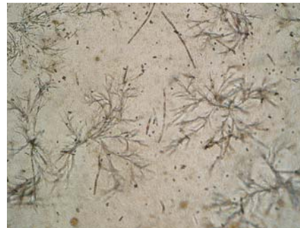
Abb.: 18 Dendritische Kristalle, Sporen und Hyphenfragmente auf dem reinen CellBen
