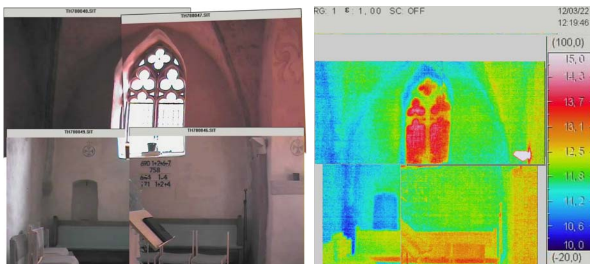
Abb.: 6 Fotomontage zur Veranschaulichung der Oberflächentemperaturen der Südwand des Chores
