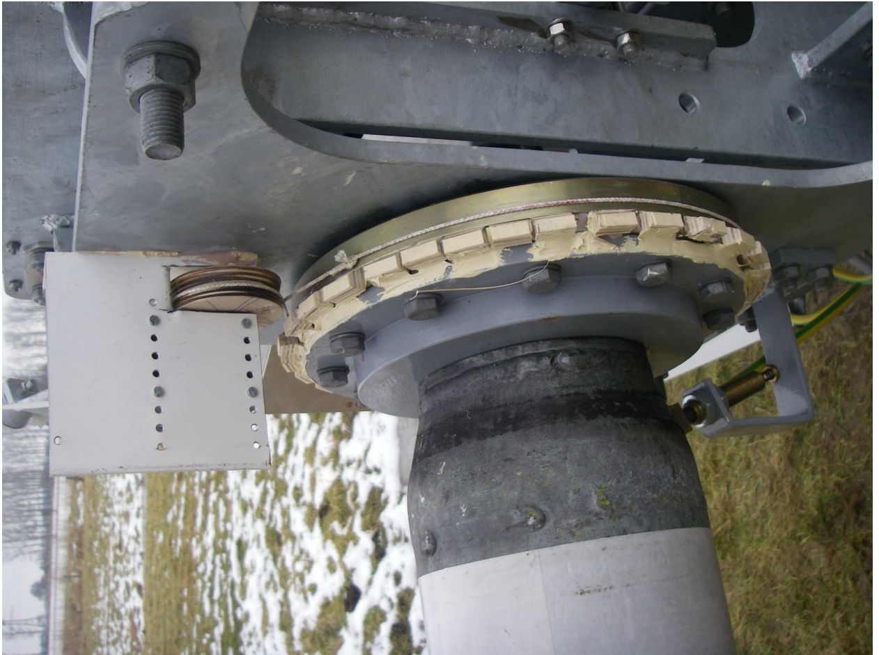
Abb. 1 Messaufbau yaw- Verhalten
