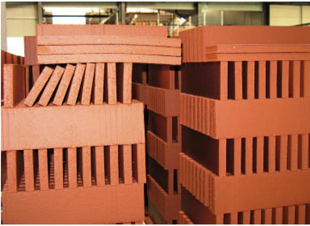
Abbildung 25: Tunnelofenwagen mit Besatz, eine Lage ist durch die Schubbeschleunigung gekippt.
