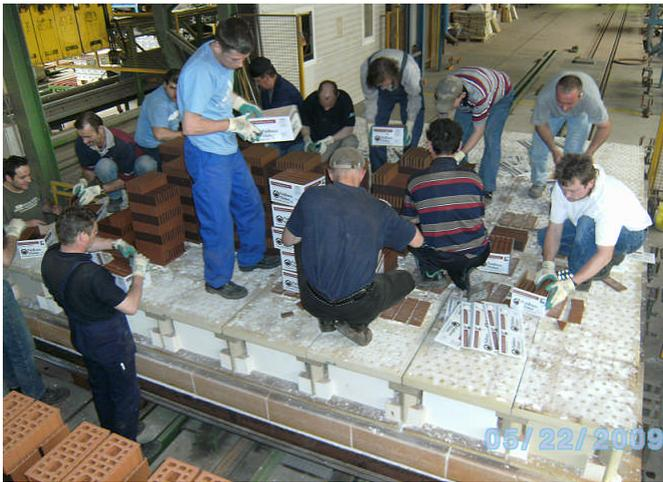
Abbildung 26: Sortieren und Entladen des ersten, gebrannten Besatzes.
