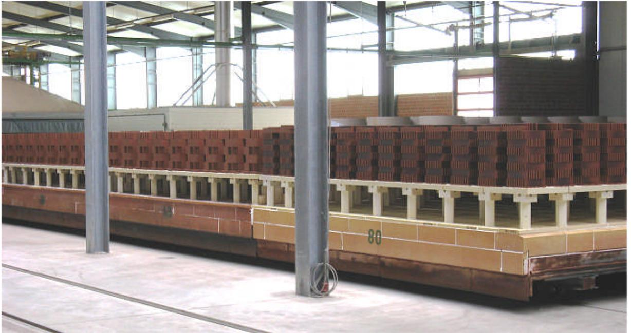
Abbildung 29: Glasierte Klinkerriemchen bei Ofenausfahrt
