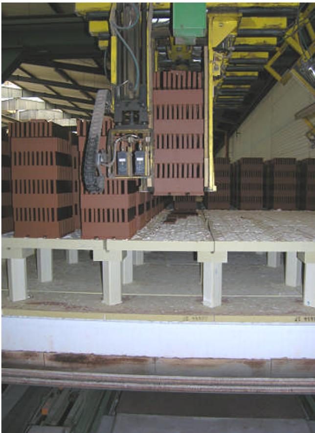
Abbildung 28: Vorsichtiges Anheben der gebrannten und glasierten Türmchen dank neuer Programmierung der Entladeroboter
