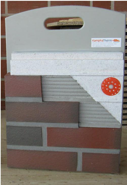
Abbildung 1: WDS mit Formteilen aus Hartschaum, der auf die Außenwand gedübelt wird. Die Klinkerriemchen werden aufgeklebt.
