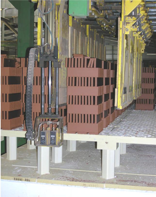
Abbildung 27: Die Greifer der Abladeroboter bei Zugriff auf den Besatz
