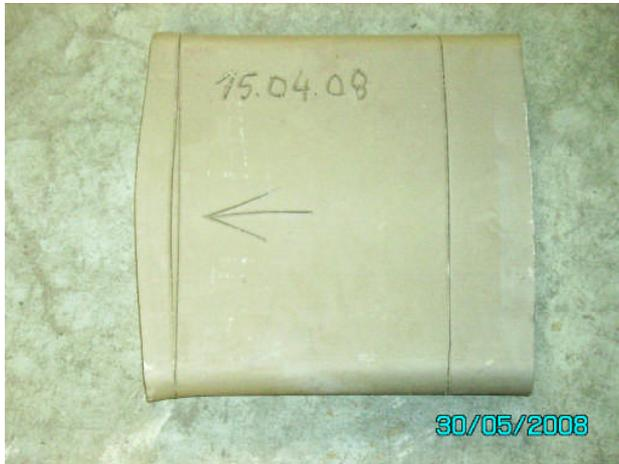
Abbildung 6: Strangabschnitt mit ungleichmäßigem Vortrieb, links ist der Vortrieb mittig mit ca. 7 mm zu erkennen.
