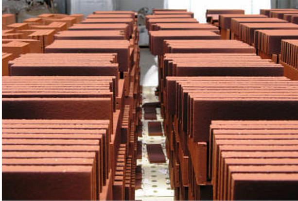
Abbildung 24: Tunnelofenwagen mit Besatz, die glasierten Riemchen sind durch den Schub teilweise verschoben.
