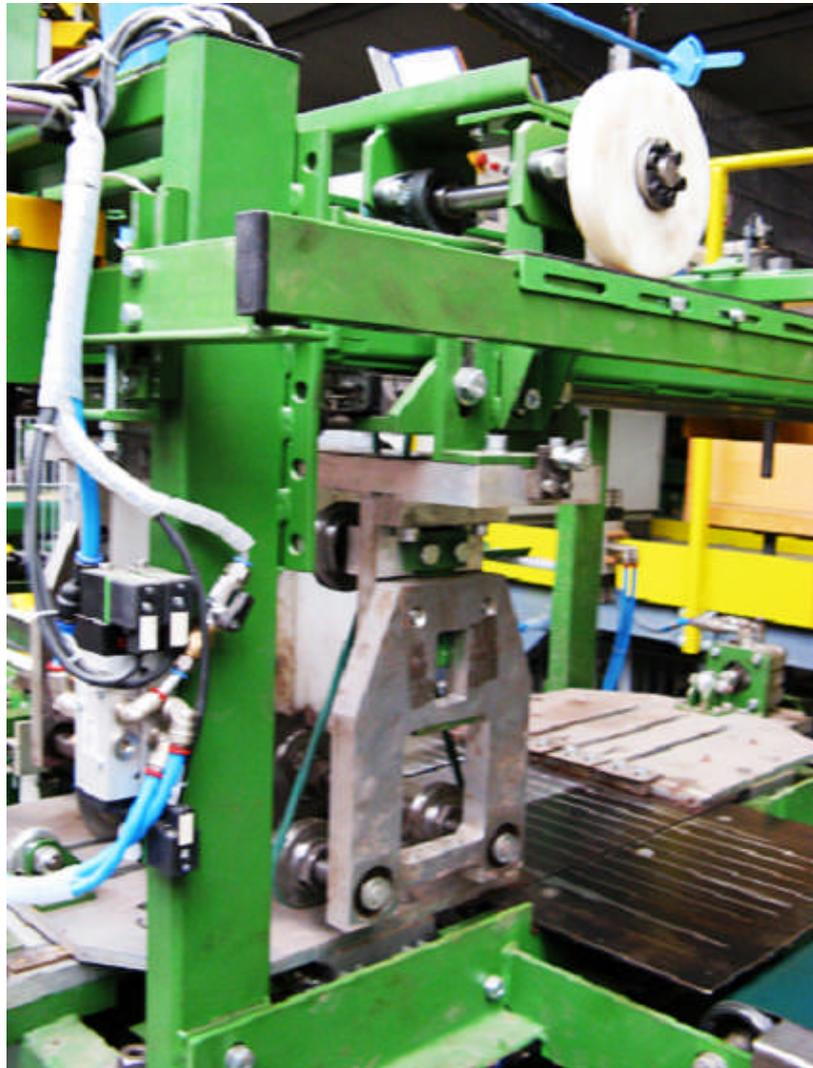
Abbildung 18: Riemchenschnitt mit 3 Schneidscheiben auf zwei Achsen (endgültige Ausführung)
