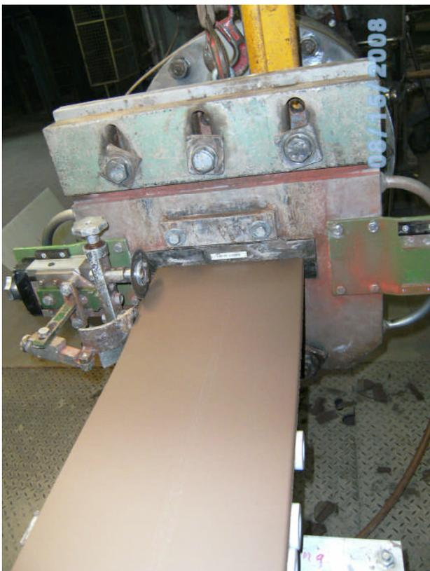
Abbildung 9: Auslaufender Strang beim zweiten Pressversuch mit dem korrigierten Presskopf nach Abbildung 8
