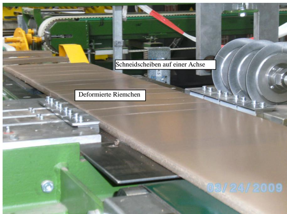
Abbildung 15: Versuch mit drei Schneidscheiben
