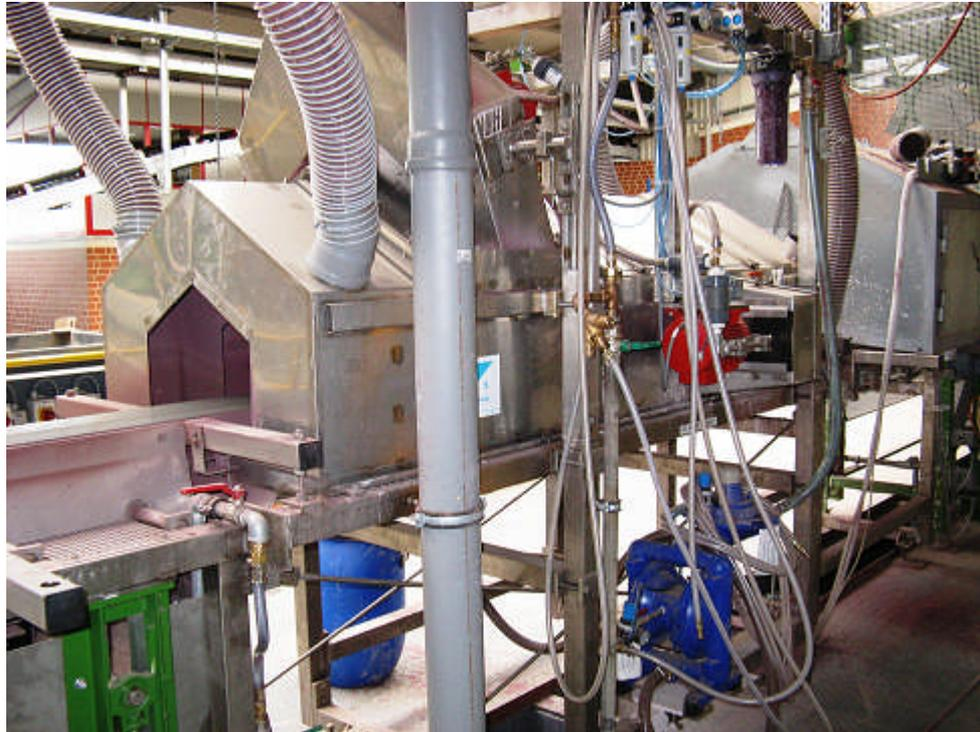
Abbildung 13: Auftrag der Glasurflüssigkeit und Vortrocknung (rechts)
