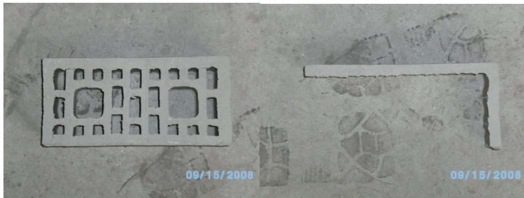
Abbildung10: Trägerstein mit Winkelriemchen, rechts das glasierte, abgelöste Winkelriemchen
