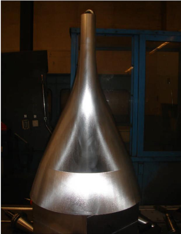
Abbildung 4: Gefrästes Negativ des Presskopfs
