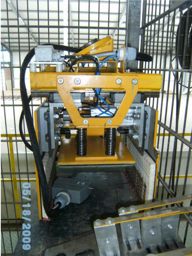
Abbildung 22: Druckplatten an den Greifern der Setzroboter
