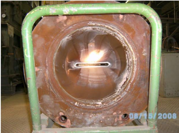
Abbildung 8: Blick in Flussrichtung auf den neuen Presskopf
