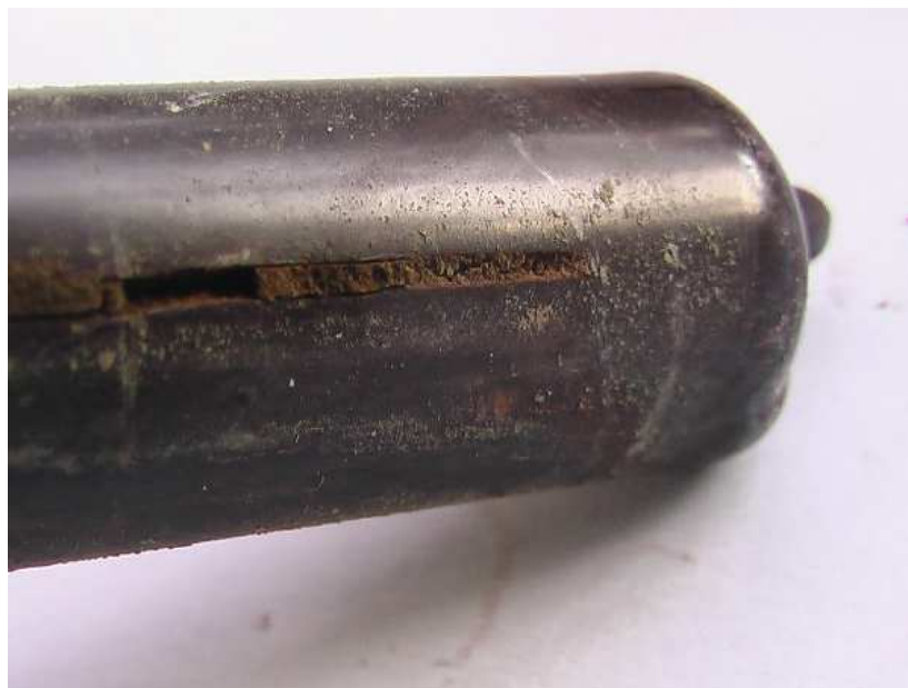
Bild 11: Foto eines Probestabs nach 1-monatigem Biokorrosionstest
