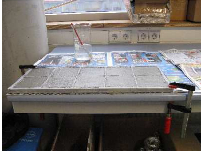
Abbildung 1: Herstellung der Betonproben
