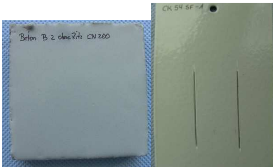
Abbildung 2 und 3 zeigt die für den Salzsprühtest hergestellten Probenarten (li: Betonprobe; re: Stahlprobe)
