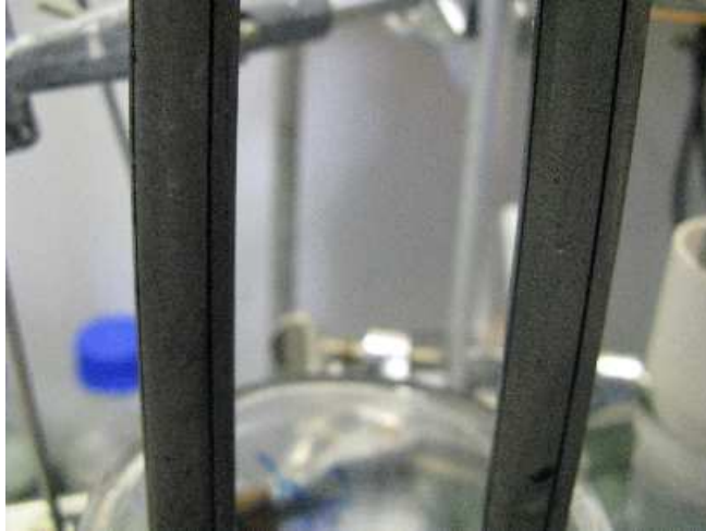
Bild 8 Beschichtete Proben mit Ritz zur Untersuchung der Biokorrosion
