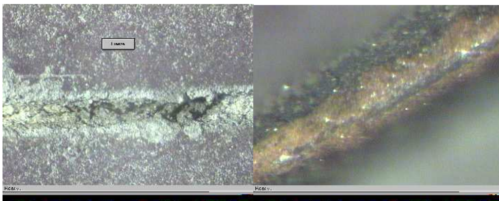
Bild 12a/b: Lichtmikroskopische Aufnahme eines Teilstücks am Ritz nach der Biokorrosion
