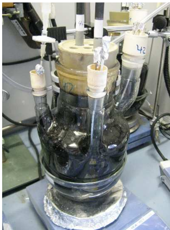
Bild 7 Bioreaktor zur Untersuchung der Biokorrosion
