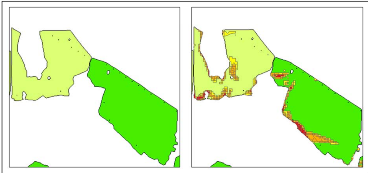
Abbildung 13: links LUNG-Erosionskataster mit Feldblockgrenzen, Raster 25x25m, rechts gleiche Abbildung überlagert von Enat-Stufen 3, 4 und 5 (gelb, orange und rot) des genaueren LUNG-Modells
