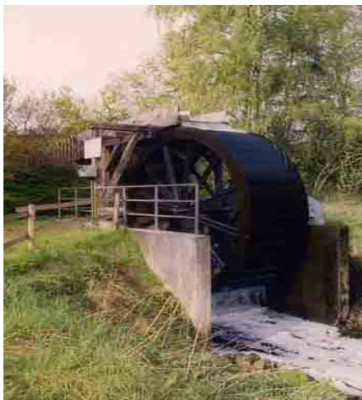
Bild 11: Oberschlächtiges Wasserrad (14 kW, Durchmesser 4,8 m) am Auslauf des Klärwerks Warendorf (Quelle: Bega Wasserkraftanlagen GmbH, Bochum)
