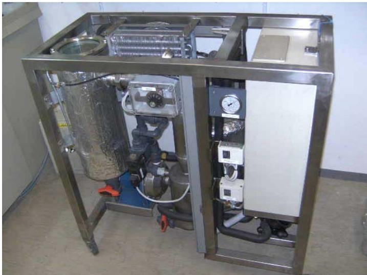
**Abbildung 9: Labor-Vakuumverdampfer**
