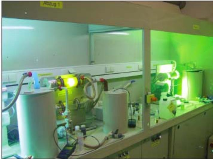
**Abbildung 8: Labor Enviolet® UV-Anlagen (verschiedene Anlagen mit wählbaren UV-Reaktoren und UV-Strahlern)**
