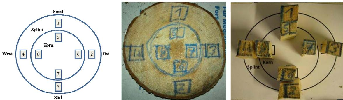
Abb.6: Prüfkörperentnahme an den Stammscheiben für Holzdicthebestimmungen, links schematisch, in der Mitte vor Entnahme aus einer Stammscheibe, rechts die gewonnenen Prüfkörper.
