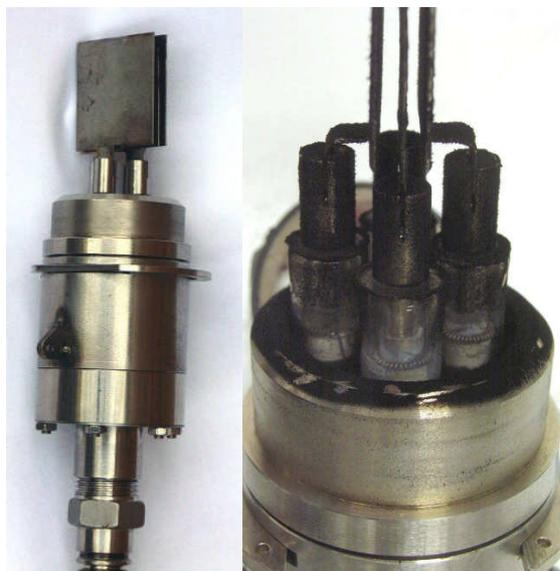
Abb.: 1-4 Sensorkopf mit neuer Elektrodenform
