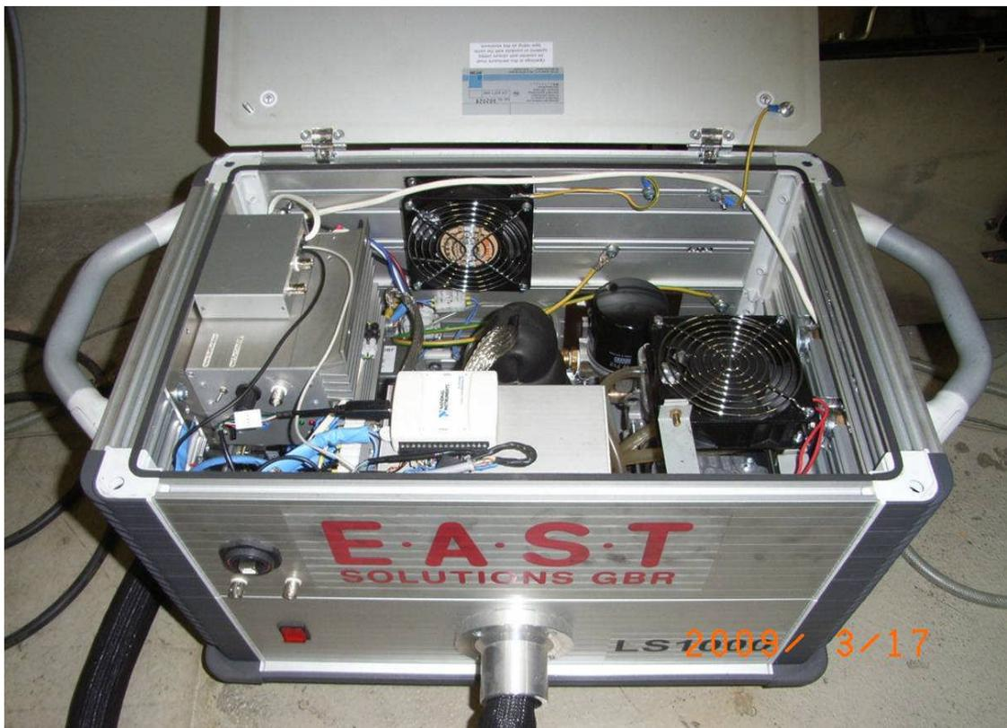
Abb.: 2-16 1. Ausführung des Rußmessgerätes
