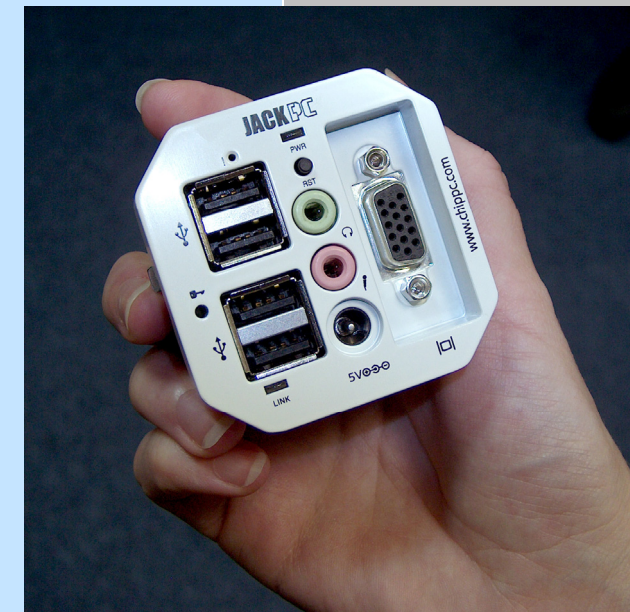
Kompletter Thin Client mit PoE (Verbrauch <10 Watt) [Chip PC]
