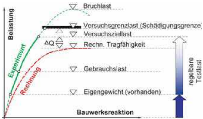
Grafik 2: Sicherheitskonzept der Belastungsversuche, aus Deutsches Ingenieurblatt, Rettung vor dem Garaus, Fiedler, Kapphahn, Steffens, Berlin 5/2008
