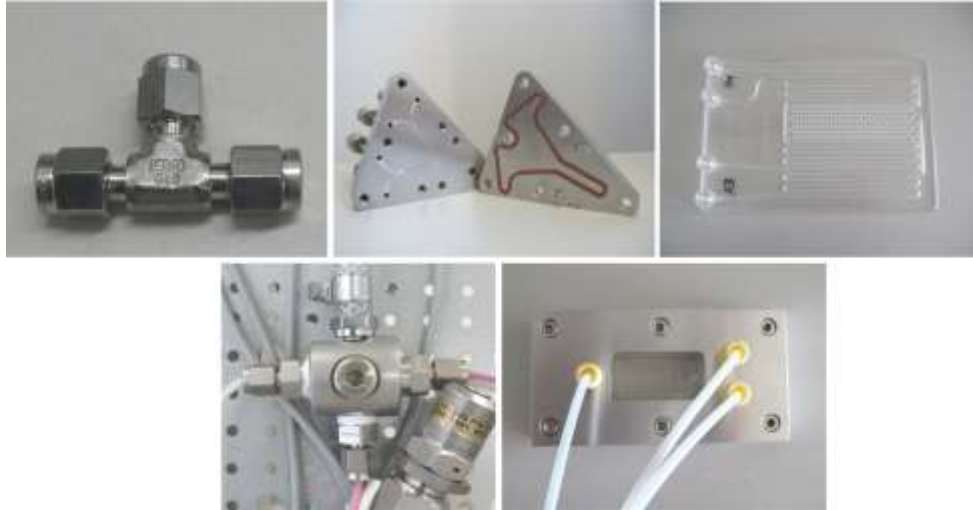
Abbildung 4: Getestete Mikromischer, im Uhrzeigersinn von links oben: Swagelok T-Stück, IMM Raupenmischer, LTF Schikanenmischer, mikroglas Interdigitalmischer, Synthesechemie MicroJetReactor
