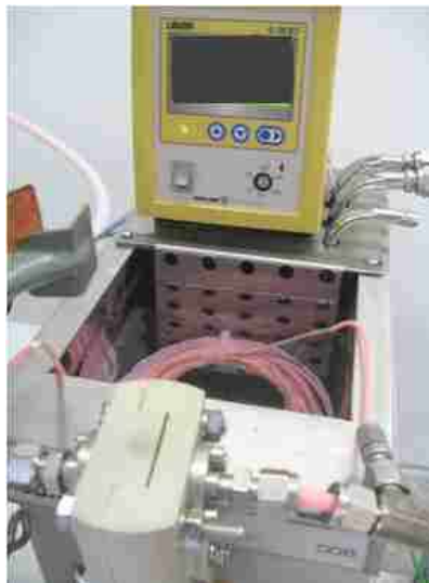
Abbildung 14: Zur Farbreaktion ins Bad eines Thermostaten eingelegte Verweilzeitstrecke
