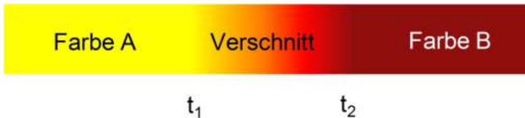
Abbildung 18: Verschnitt bei Umstellung von Farbe A auf Farbe B, t_1 kennzeichnet den Zeitpunkt, an dem auf die Farbformischung B umgeschaltet wird, wohingegen bei t_2 die erste spezifikationsgerechte Farbe B im Produktbehälter ist
