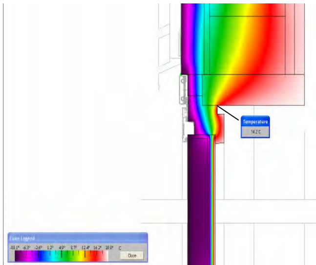
Grafik 2 Wärmebrückenbetrachtung Fensteranschluss zu Dämmebene, AB Haase
