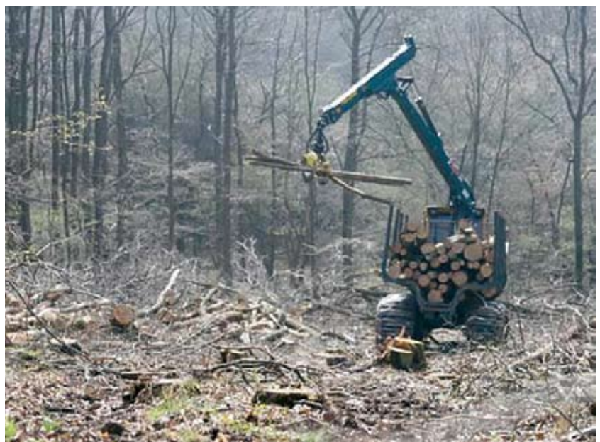
Abbildung 3: Einsatz von Laubholzharvesterkopf und Forwarder bei der Niederwaldernte. Fotos: SUCHOMEL
