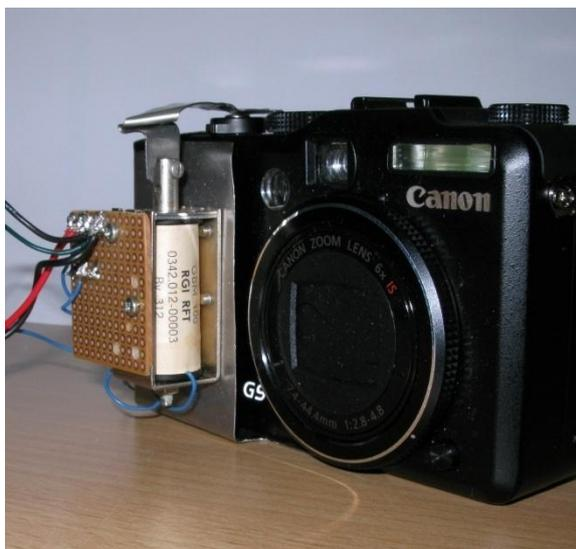
Abbildung 26: Mechanischer Bildauslösemechanismus für die Canon Powershot G9
